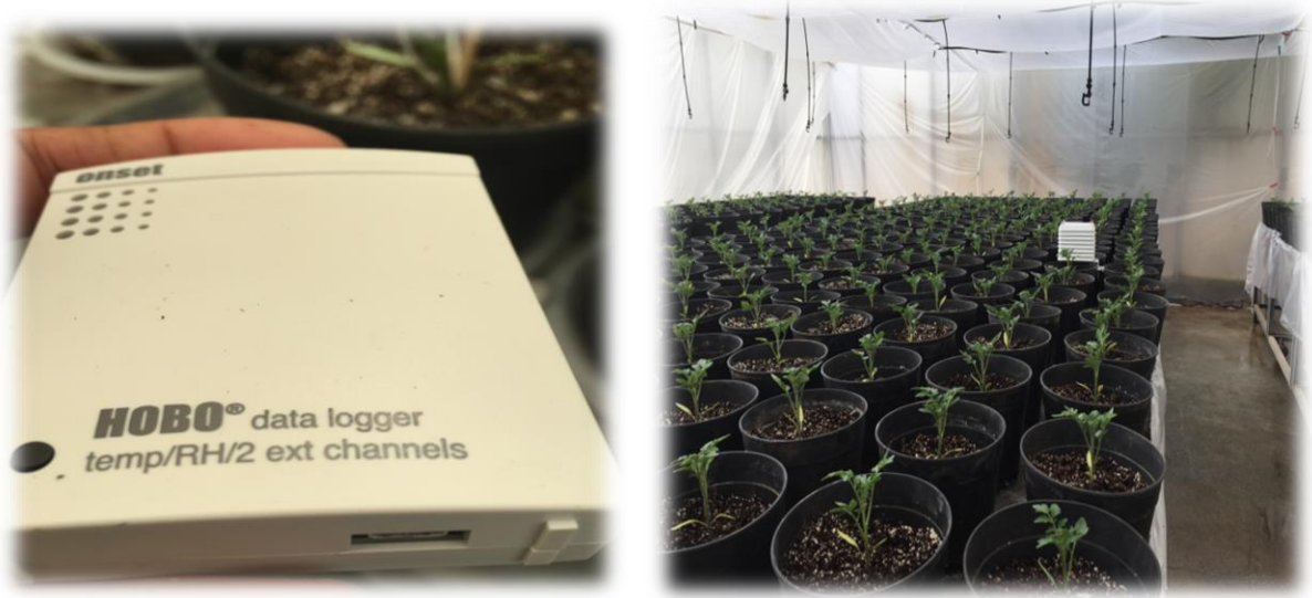
Şekil 3.3. Sıcaklık ve nem değerlendirilmesinin elde edildiği termohigrometre ve bilgi depolayıcısı (data logger) ait bir görünüm
