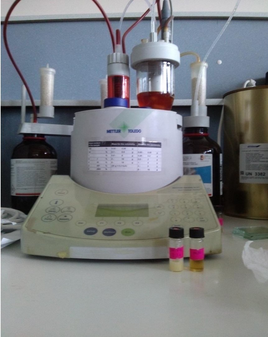
Şekil 3.8. Karl Fischer titrasyon cihazında örnek analizi
