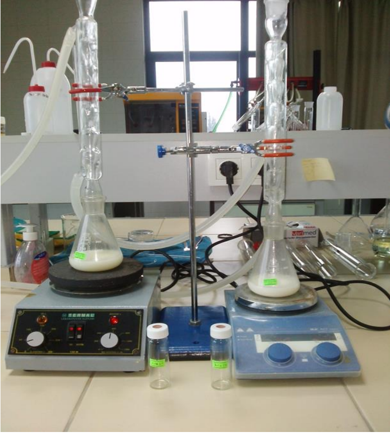
Şekil 3.2. Hamsi yağı/ \beta -siklodekstrin komplekslerinin oluşturulması aşamasında kurulan düzenek
