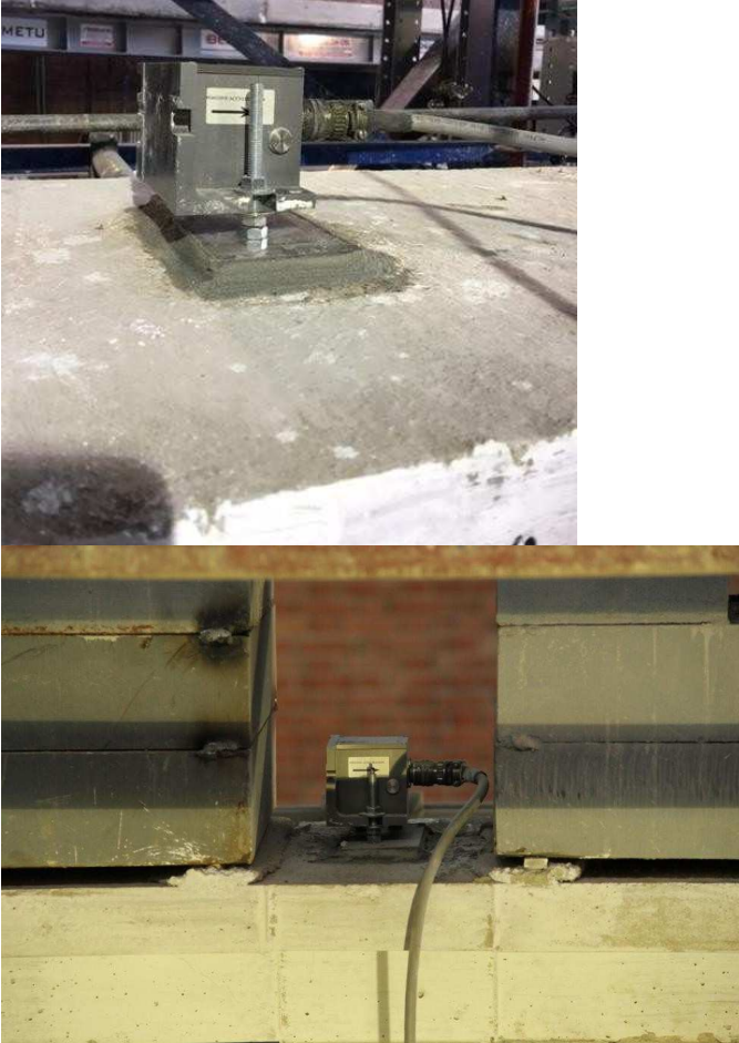
Şekil 3.11. CMG-5U model tek eksenli ivmeölçerlerin deney elemanı üzerinde sabitlenmesi
