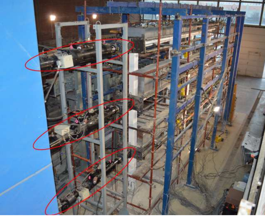
Şekil 3.24. Reaksiyon duvarına monte edilmiş deprem kayıtlarının uygulanmasında kullanılan yük hücreleri (hidrolik pistonlar)
