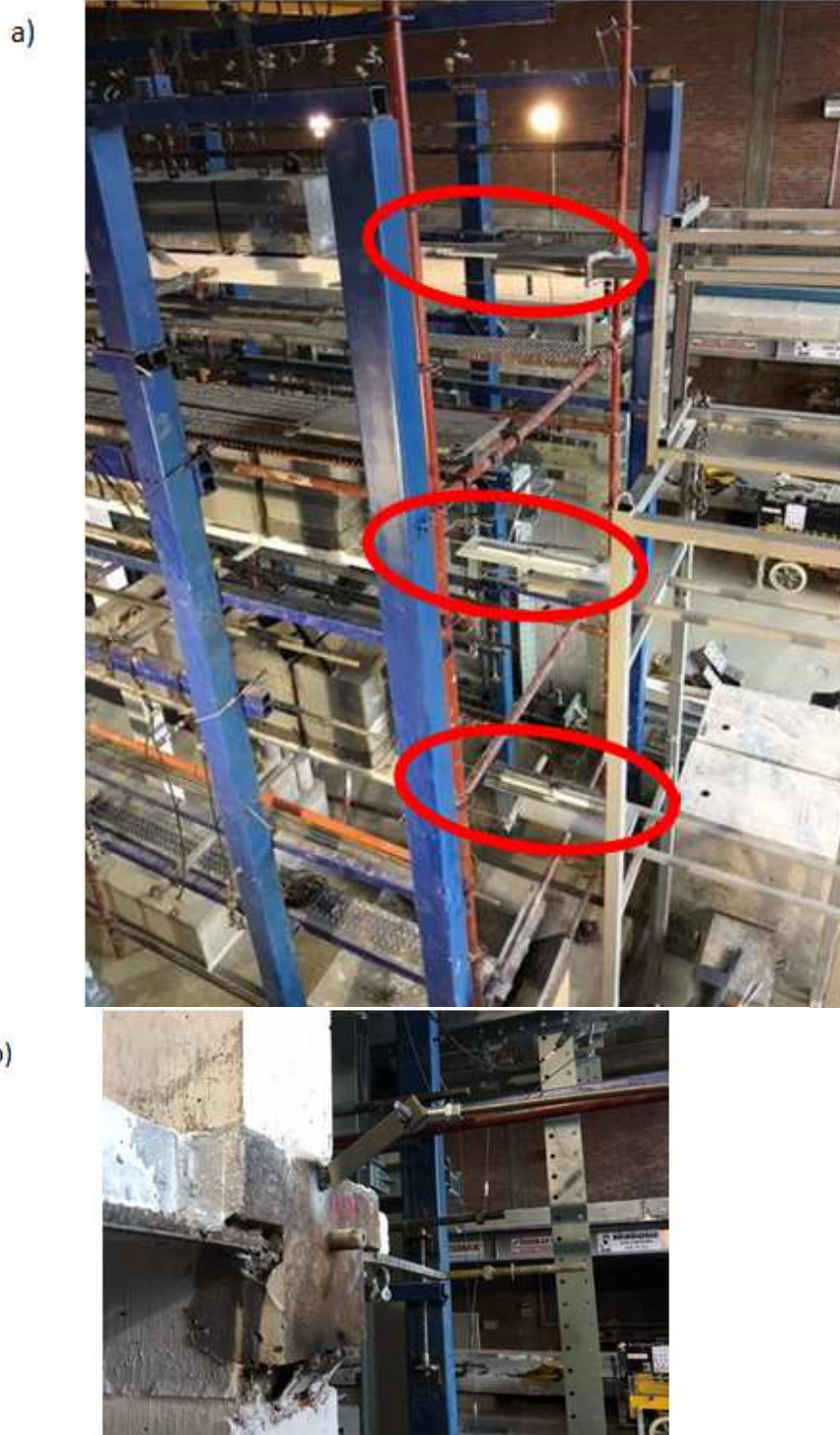
Şekil 3.7. TUBİTAK 112M820 nolu proje kapsamında test edilen deney elemanına Deplasman ölçerlerin yerleşimi a) genel görünüş b) kat seviyesindeki bağlantı detayı
