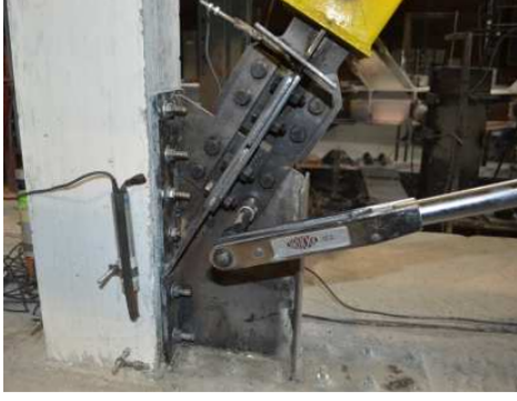
Şekil 3.19. BEÇÇ'lerin bayrak levhalarına montajı (TÜBİTAK 112M820 nolu projenin sonuç raporundan alınmıştır.)
