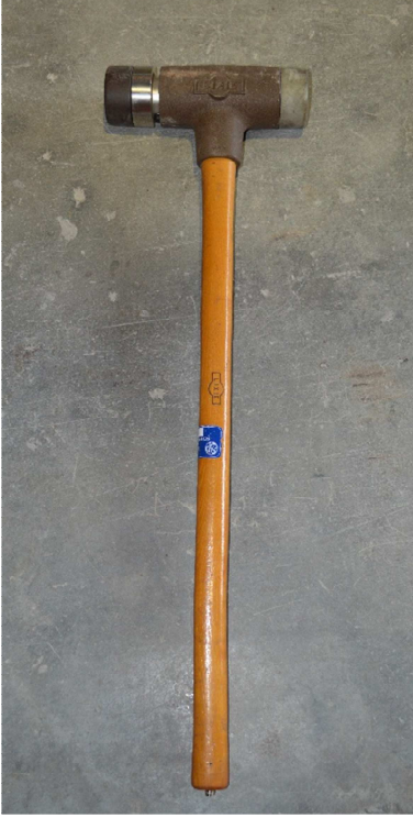
Şekil 3.8. Yapısal tanımlama testlerinde kullanılan darbe çekici (Hammer)
