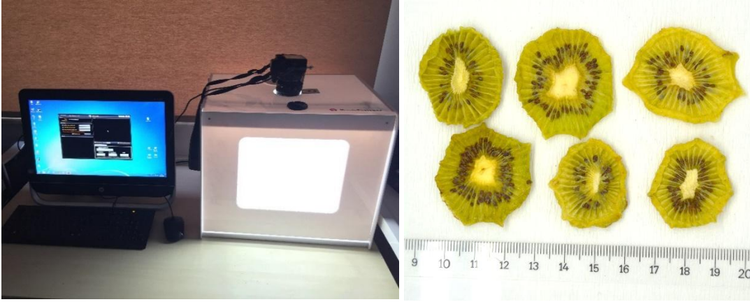
Şekil 3.9. Ürünlerin renk analizi için görüntülendiği sistem
