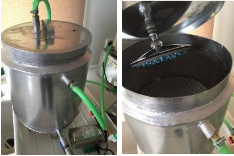
Şekil 3.8. Ozmotik kurutma işlemi için yaptırılan ceketli sistem
