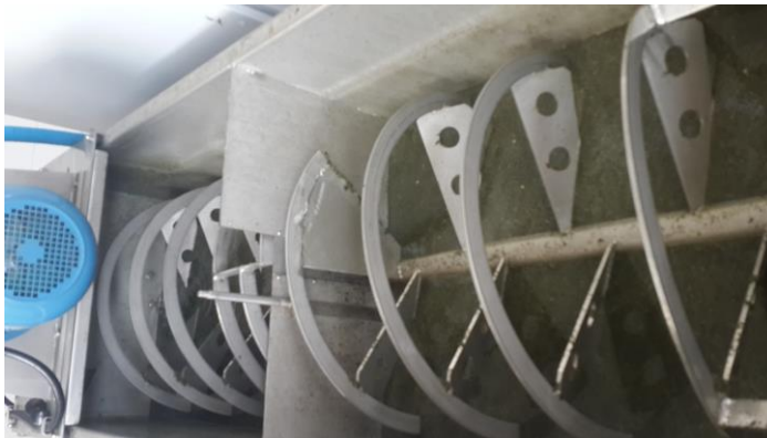
Şekil 3.4. Malaksörde stevia ekstraksiyonunun gerçekleştirilmesi
