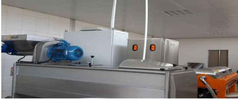
Şekil 3.3. Ekstraksiyonun gerçekleştiği kırıcı ve malaksör ünitesi
