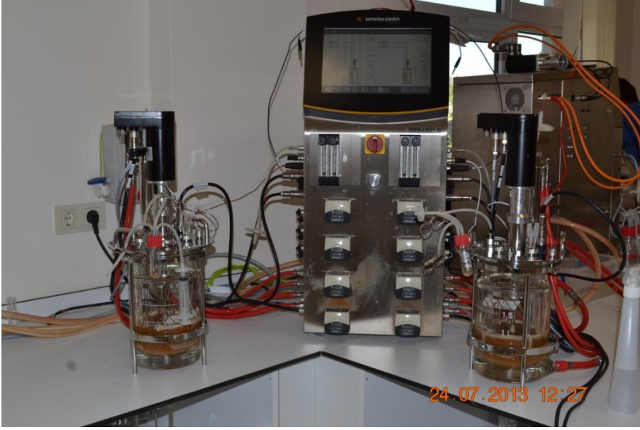
Şekil 4.6. Reaktörde etanol fermentasyonu
