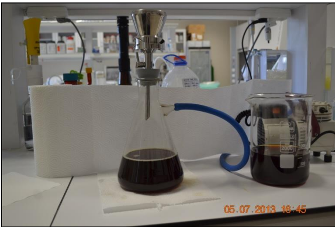
Şekil 3.5. Durultulan keçiyoynuzu ekstraktının filtre edilmesi
