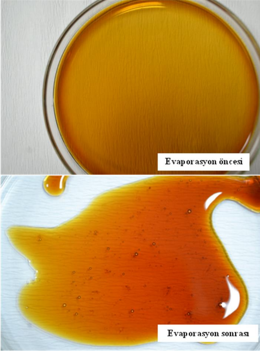
Şekil 4.8. Keçiboynuzu ekstraktının evaporasyonu
