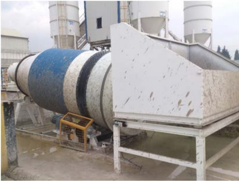
Şekil 2.5. Beton boşaltım oluğu (Coşkun 2007)
