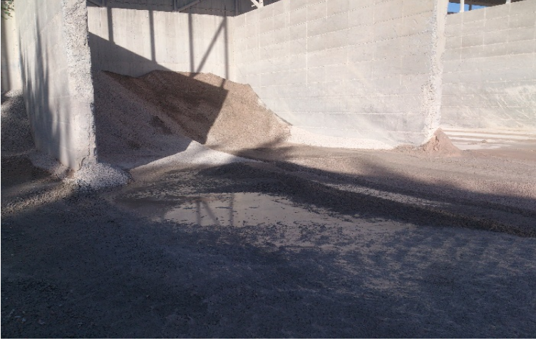
Şekil 2.15. Geri kazanılan agreganın kurutulmak üzere serilmesi
