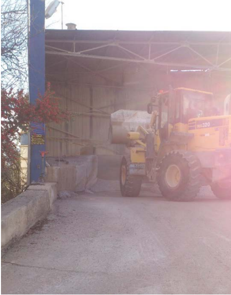
Şekil 2.16. Geri kazanılan agreganın stoktaki agregalarla harmanlanması
