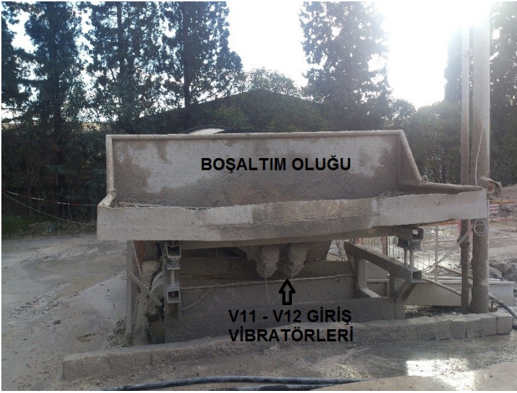
Şekil 2.12. Agreganın geri dönüşüm sistemi boşaltım oluğu ve giriş vibratörleri
