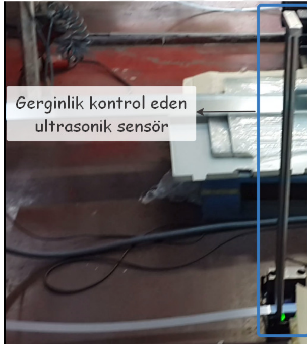
Şekil 3.2. Rulo Açıcı Önündeki Loop Mekanizması
