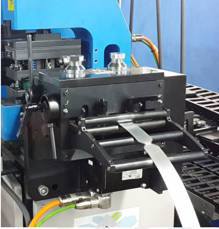
Şekil 3.5. Piston Grubu Sonundaki Saç Süren Servo Mekanizması
