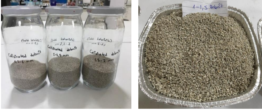
Şekil 3.2. Kalsine edilmiş farklı boyutlardaki dolomit katalizörü
