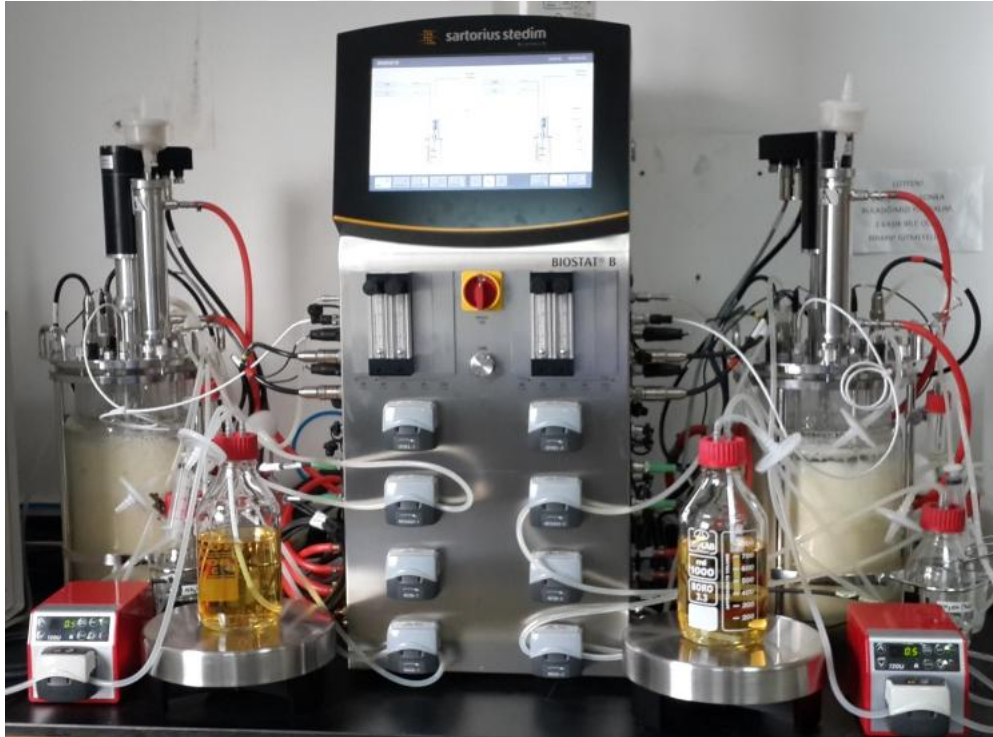
Şekil 4.61. Fermentasyonlar esnasında çekilen fotoğraf (Sistem; Sartorius stedim Biostat® B 2x5 L Bioreactor)
