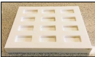
Şekil 3.2. Örneklerin polimerleştirilmesinde kullanılan teflon kalıp
