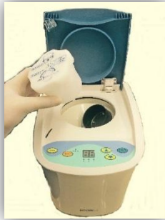
Şekil 3.3. Kompozit örneklerin hazırlanmasında kullanılan mekanik karıştırıcı
