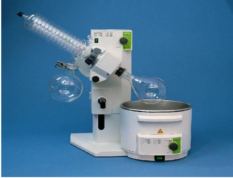
Şekil 3.1. Yoğunlaştırma işleminin yapıldığı rotavapor aleti(46)
