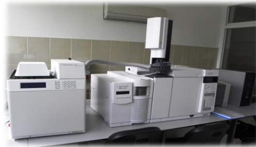
Şekil 3.12. Gaz kromatografisi/Kütle spektrometresi (GC-MS)
