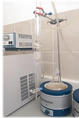
Şekil 3.3. Volümetrik nem tayin düzeneği
