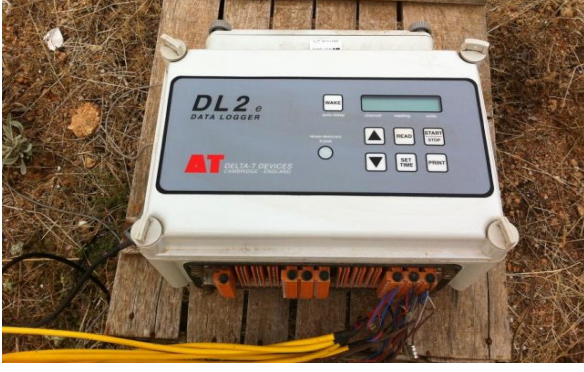
Şekil 3.6. Veri kayıt cihazı ve araştırma alanındaki konumu
