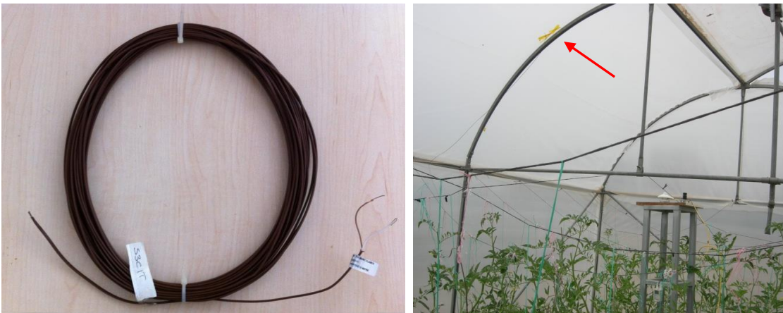
Şekil 3.5. T tipi ısıl çift ve sera içindeki konumu
