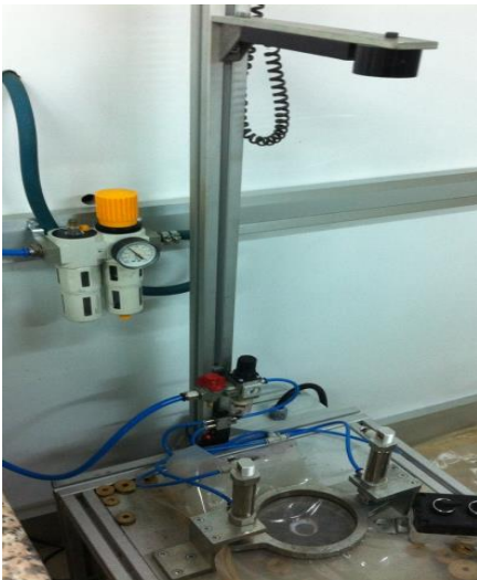
Şekil 3.12. Örnek bir darbe mukavemet testi
