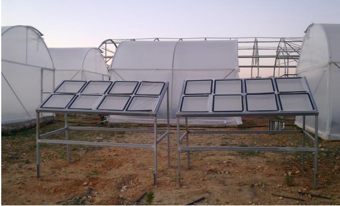
Şekil 3.7. Sera örtü malzemelerinin bazı mekanik özelliklerinin belirlenmesinde kullanılan konstrüksiyon
