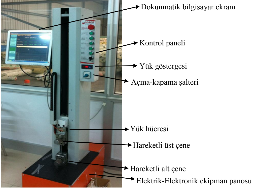
Şekil 3.8. Çekme test cihazı ve kısımları (Alarge 2010a)
