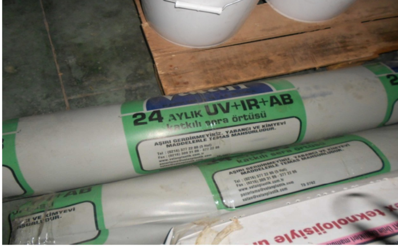
Şekil 4.24: UV+IR+AB Katkısı İçeren Polietilen Sera Örtüsü
