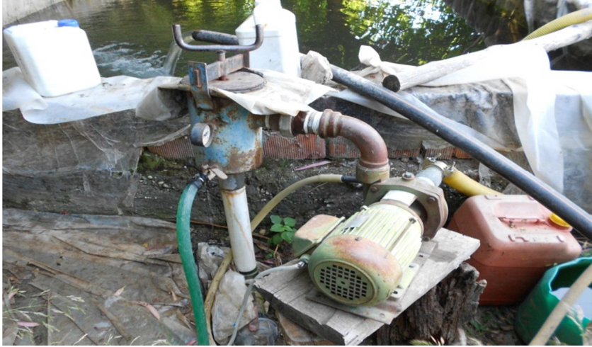
Şekil 4.39: Geleneksel Tarım İşletmesi Sulama ve Gübre Ünitesi
