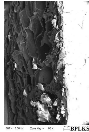
Şekil Hata! Belgede belirtilen stilde metne rastlanmadı..16. BP nişastasına yardımcı malzemeler ilave edilerek üretilen tabakların kesit SEM görüntüleri
