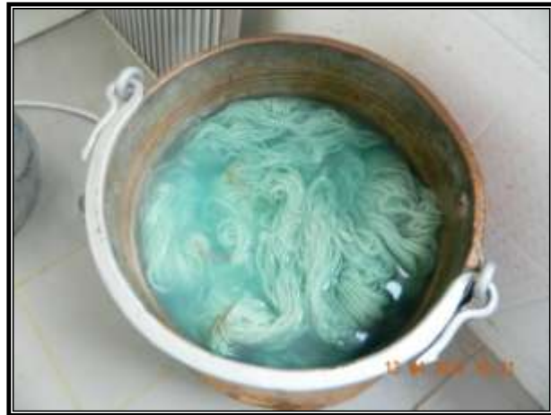
Foto.3.4 Bakır sülfat ile yapılan mordanlama işlemi
