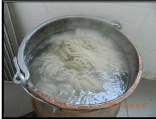
Foto.3.1 Şap ile yapılan mordanlama işlemi
