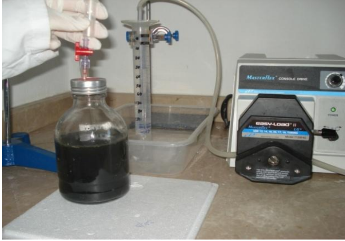
řekil 3.3. Biyogaz miktarı ölçüm düzeneęi
