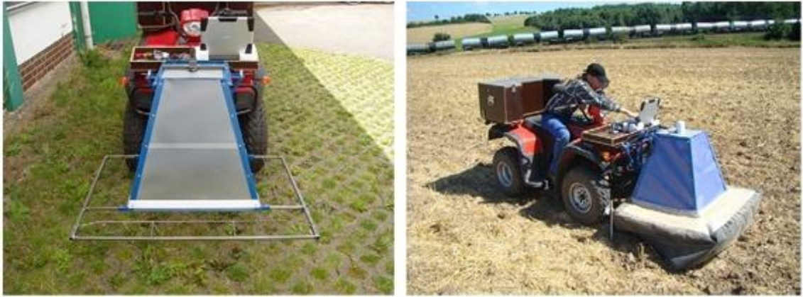
Şekil 2.37. Anız yoğunluğu ölçüm sistemi (Pforte ve Hansel 2010)
