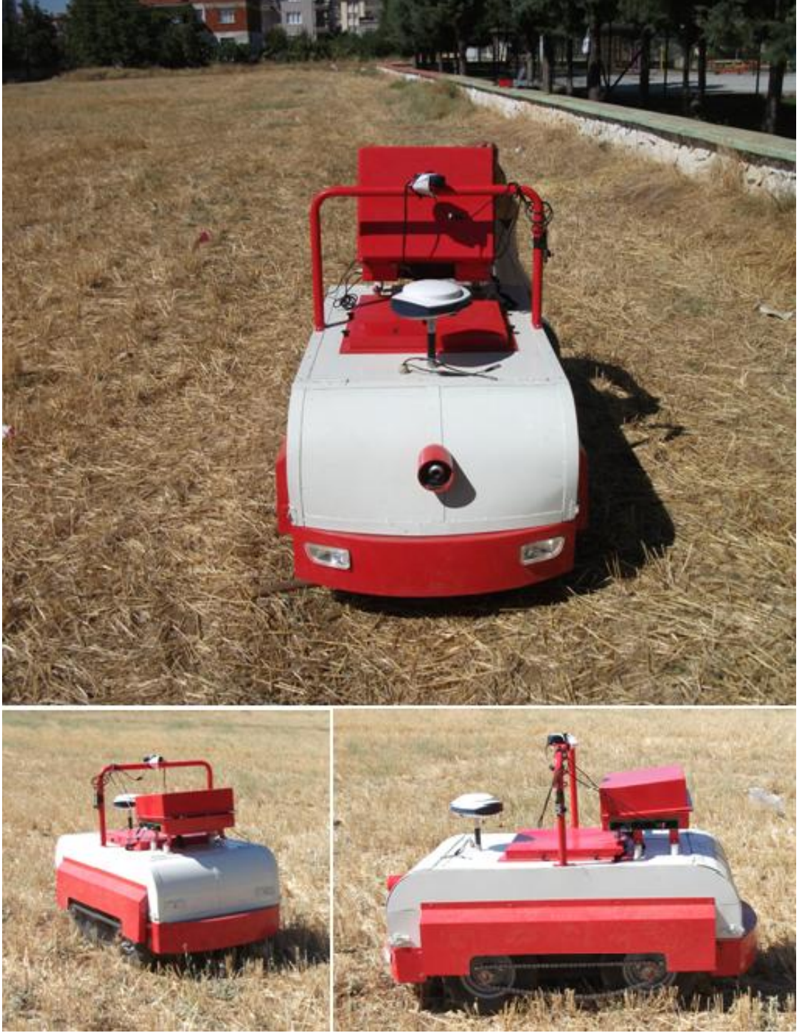
Şekil 3.2. GPS yönlendirmeli tarımsal robot
