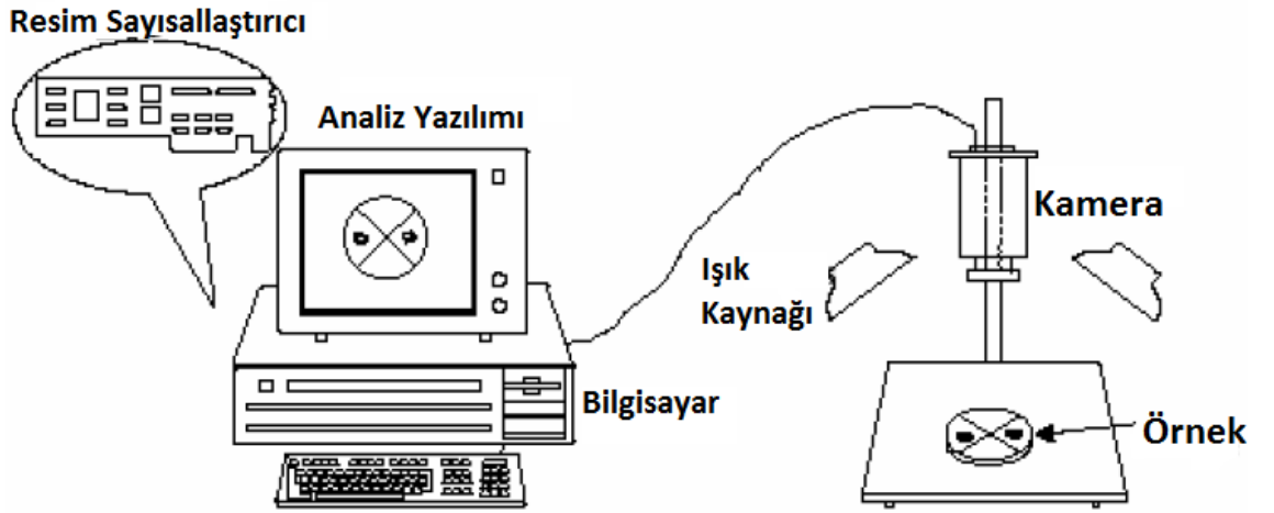
Şekil 2.31. Görüntü işleme sistemi bileşenleri (Wang ve Sun 2002)
