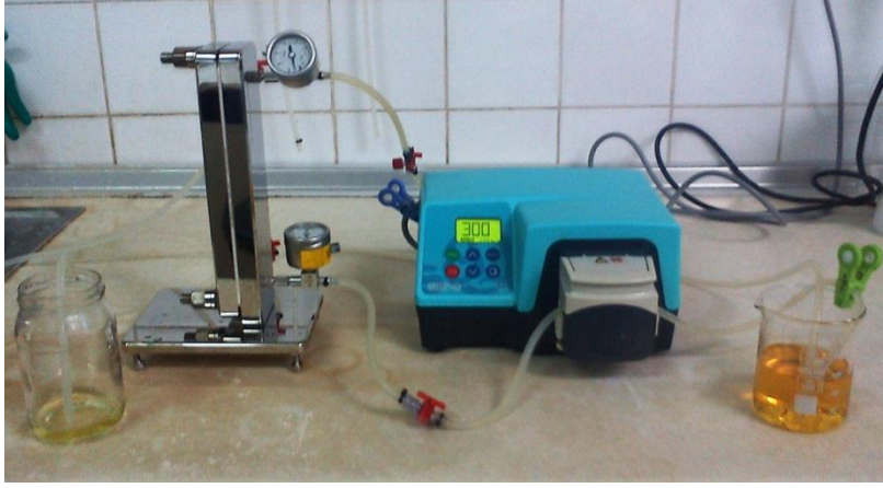
Şekil 3. 2. Laboratuvar tipi ultrafiltrasyon sistemi
