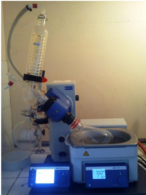
Şekil 3. 3. Laboratuvar tipi evaporatör
