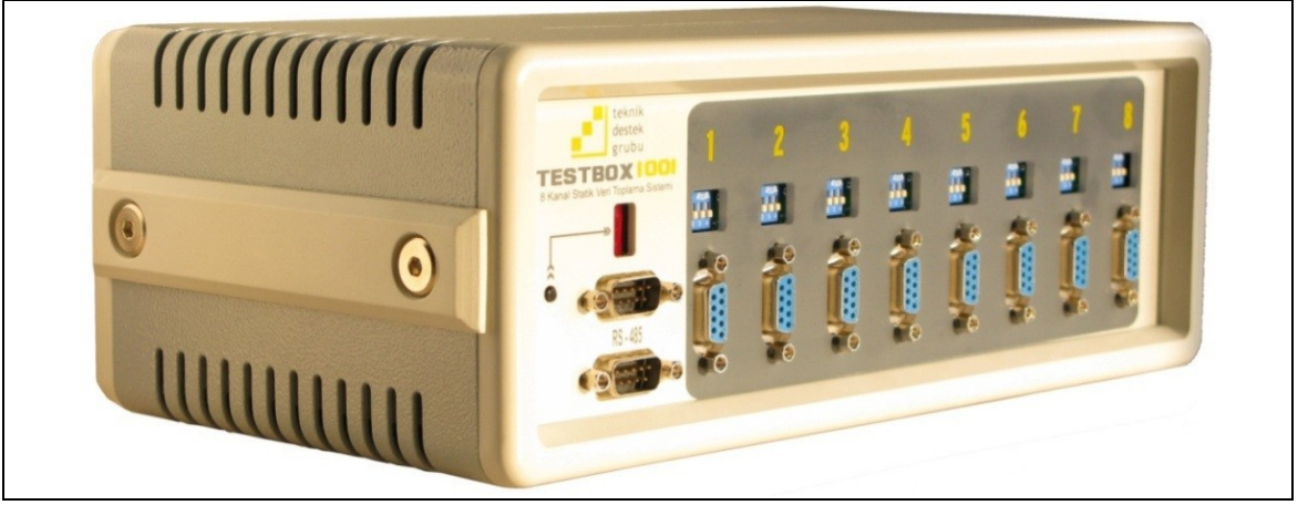
Şekil 3.9. Veri toplama cihazı (TestBox 1001)
