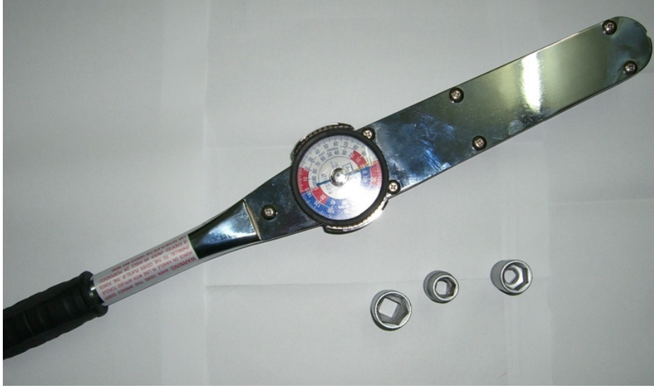
Şekil 3.4. Tronic AT-1003-LDIN analog göstergeli torkmetre
