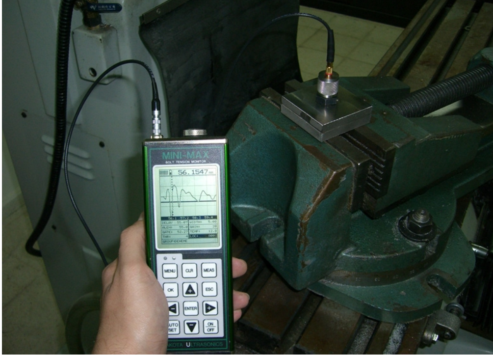
Şekil 3.15. Civata boyunun ölçülmesi
