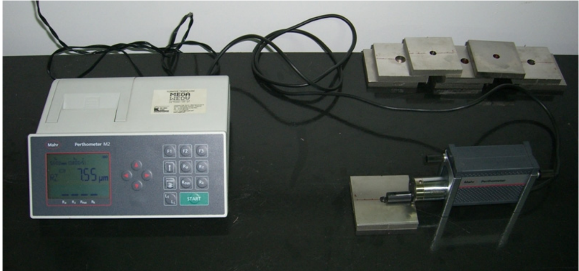
Şekil 3.14. Flanşların yüzey pürüzlülüğünün ölçülmesi
