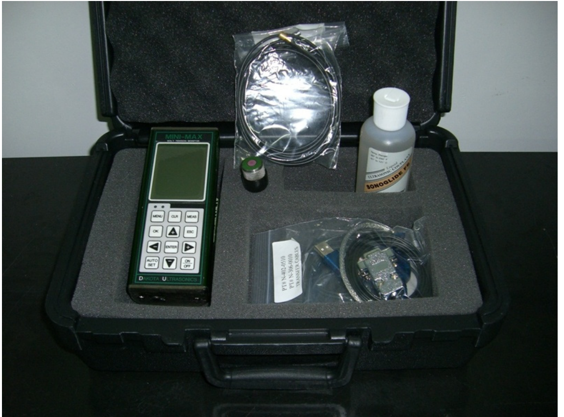
Şekil 3.5. Mini-Max ultrasonik civata ölçüm cihazı
