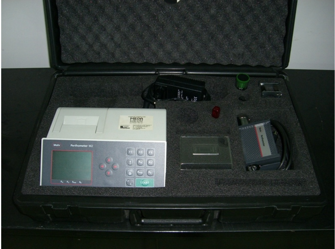
Şekil 3.3. Mahr yüzey pürüzlülük ölçüm cihazı
