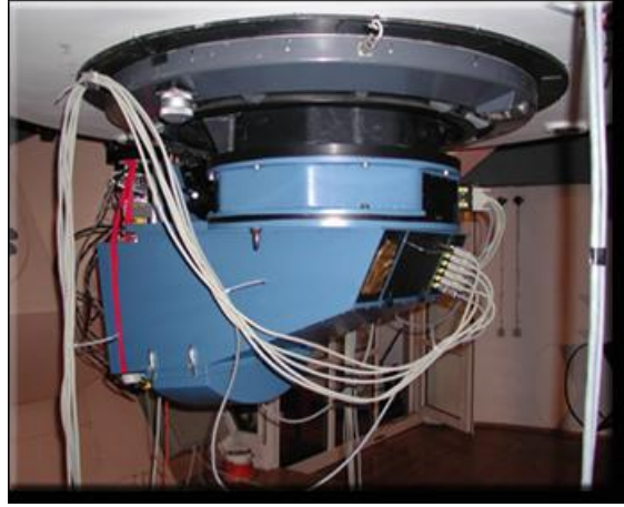
Şekil 3.1. TFOSC'un RTT150 teleskobunun odak düzlemine takılı görünümü (Aslan vd 2004)
