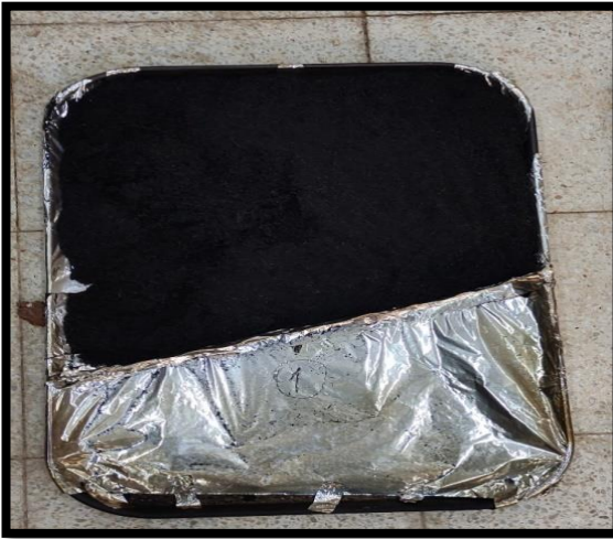
Şekil 3. 4. Muz atıklarının piroliz işlemi sonrası görselleri (Biyokömür)
