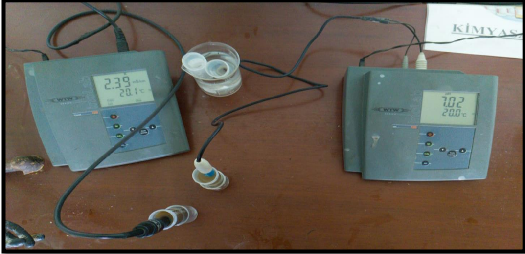
Şekil 3. 15. Ortamların pH ve EC ölçümleri görseli
