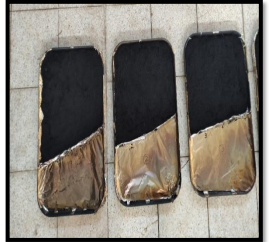
Şekil 3. 4. Muz atıklarının piroliz işlemi sonrası görselleri (Biyokömür)
