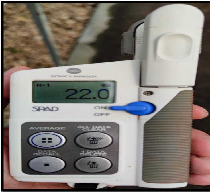
Şekil 3.22. Klorofil ölçümleri için kullanılan klorofil metrenin görseli
