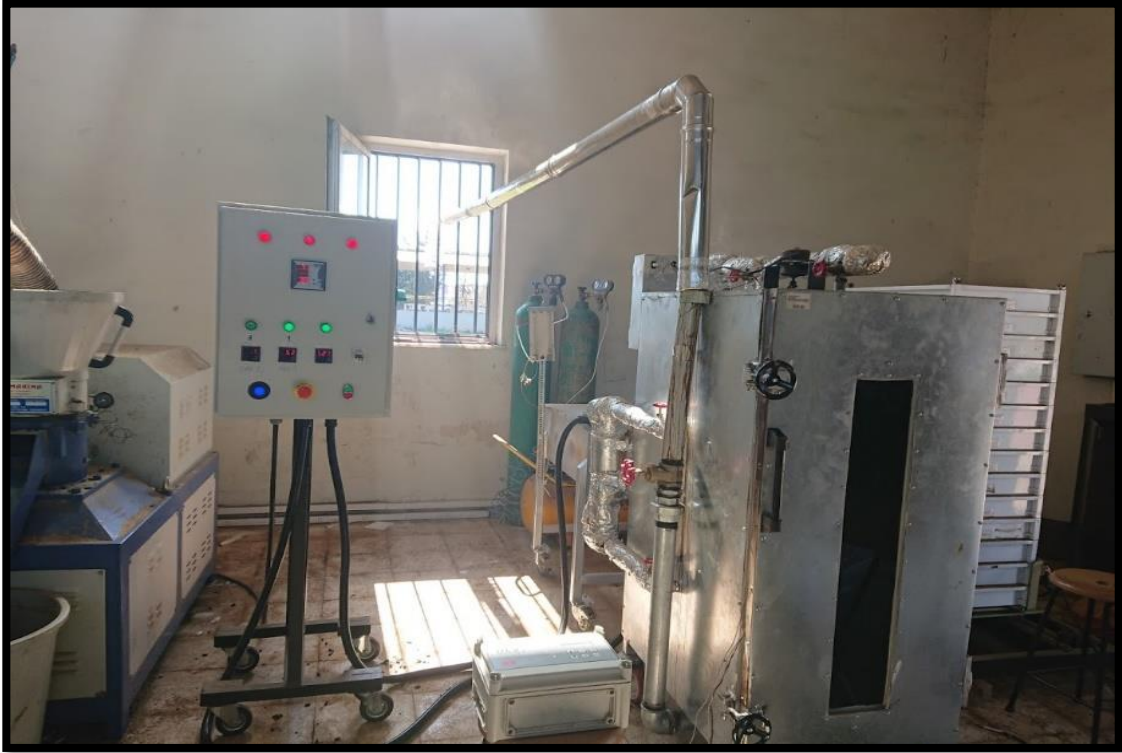
Şekil 3. 5. Denemelerde kullanılan piroliz reaktörünün görseli
