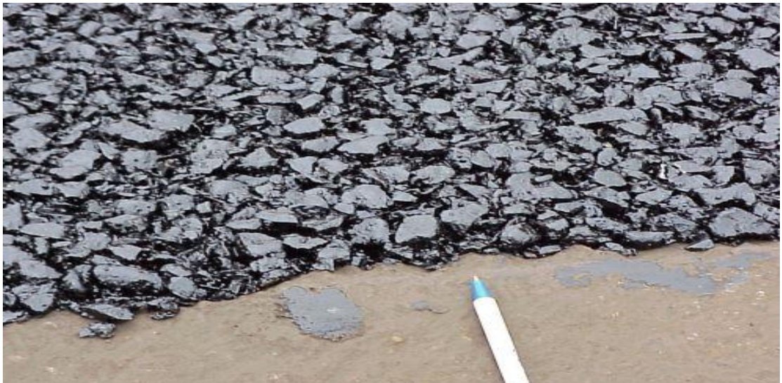
Şekil 3.9. İri gradasyonlu poroz asfalt (Randy, 2007)
