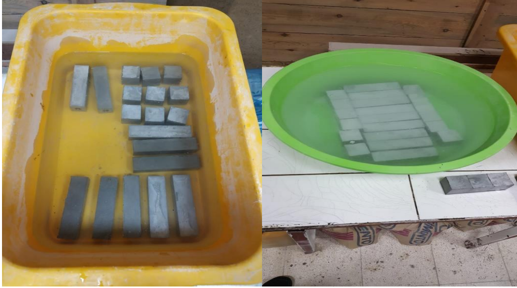
Şekil 3.7. Numunelerin kırım öncesi kürelemeye tabi tutulması
