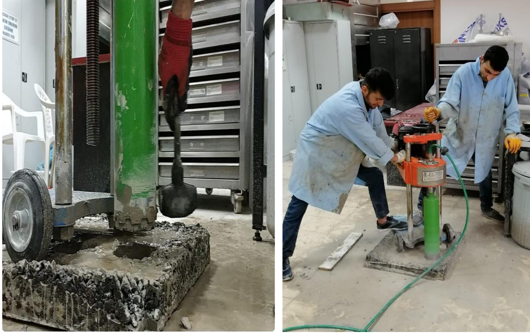
Şekil.3.16. Karot alma uygulaması
