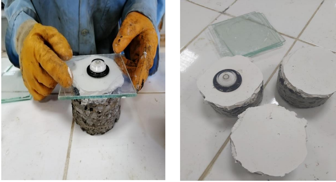
řekil 3.18. Basınç deneyi için numune yüzey hazırlığı
