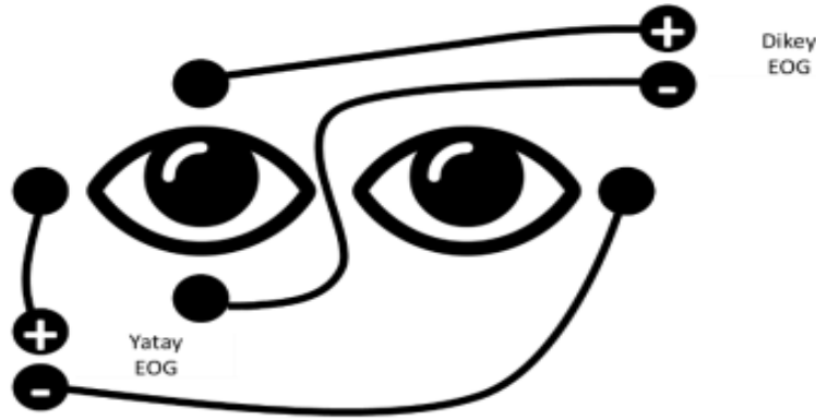
Şekil 2.7. Elektrotların temsili yerleşimi (Menteş vd. 2020)
