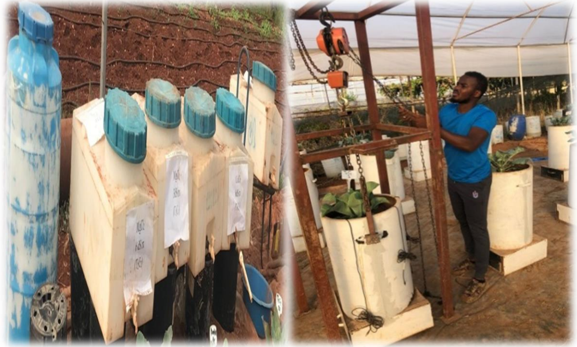
Şekil 3.6. Deneme de kullanılan su bidonları ve tartım düzeneği
