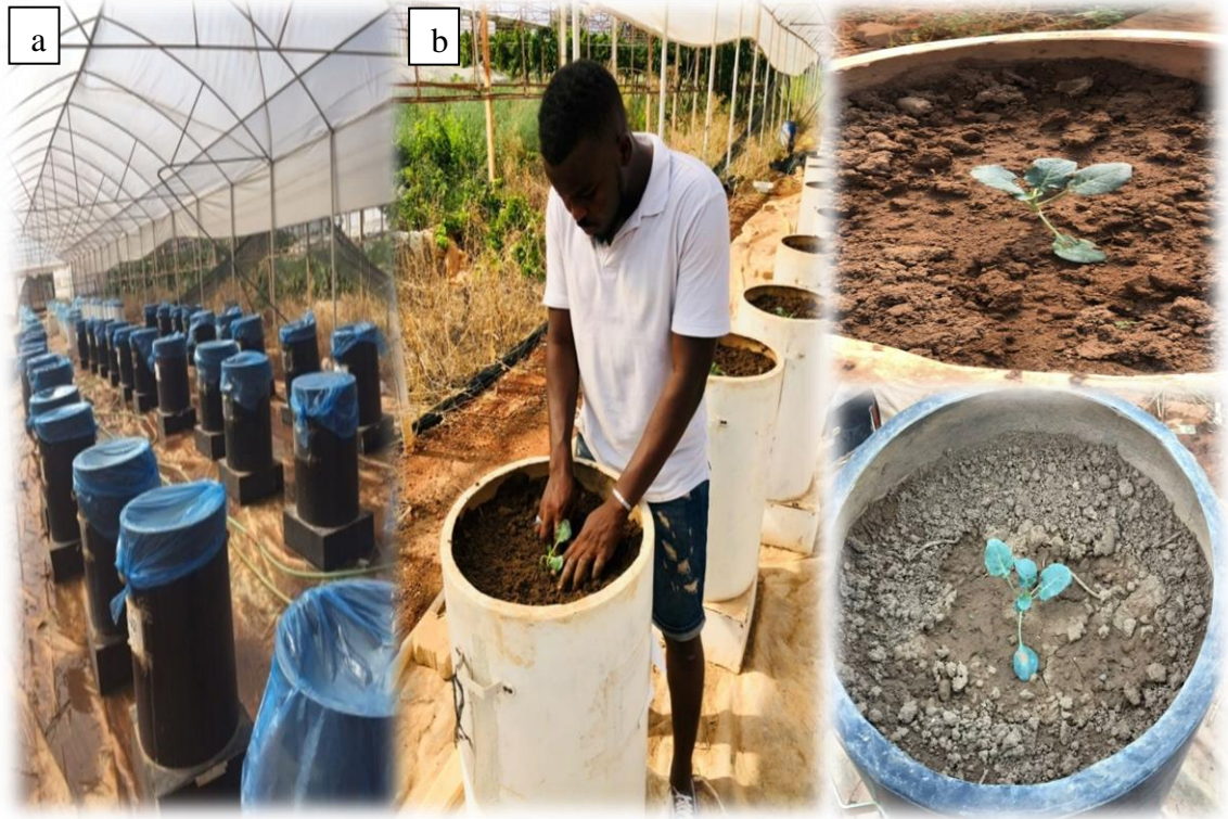
Şekil 3.5. Lizimetre topraklarının tarla kapasitelerinin belirlenmesi (a) ve fide dikimi (b)
