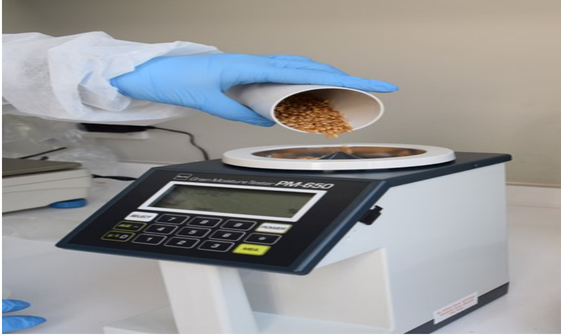
Şekil 3.2. Svevo buğdayının hektolitre ağırlığının belirlenmesi
