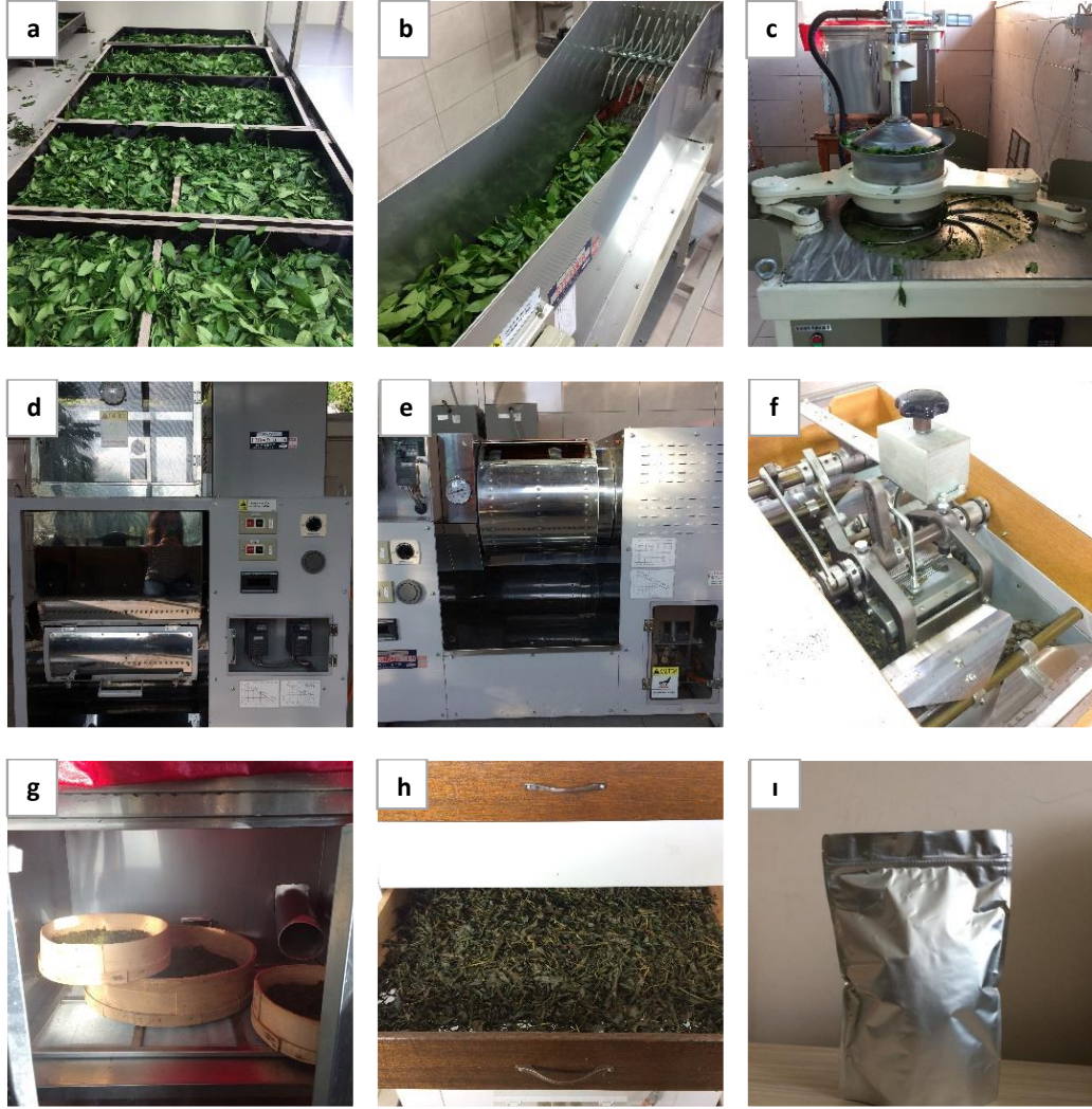
Şekil 3.1. Çayların üretimi işlem aşamaları ve muhafazası; a) soldurma; b) buharlı ısıtma işlemi; c) ortodoks kıvrırma; d) 1. döner tamburlu kıvrırmalı kurutma; e) 2. döner tamburlu kıvrırmalı kurutma; f) son kıvrırmalı kurutma; g) fermentasyon; h) son kurutma; i) muhafaza
