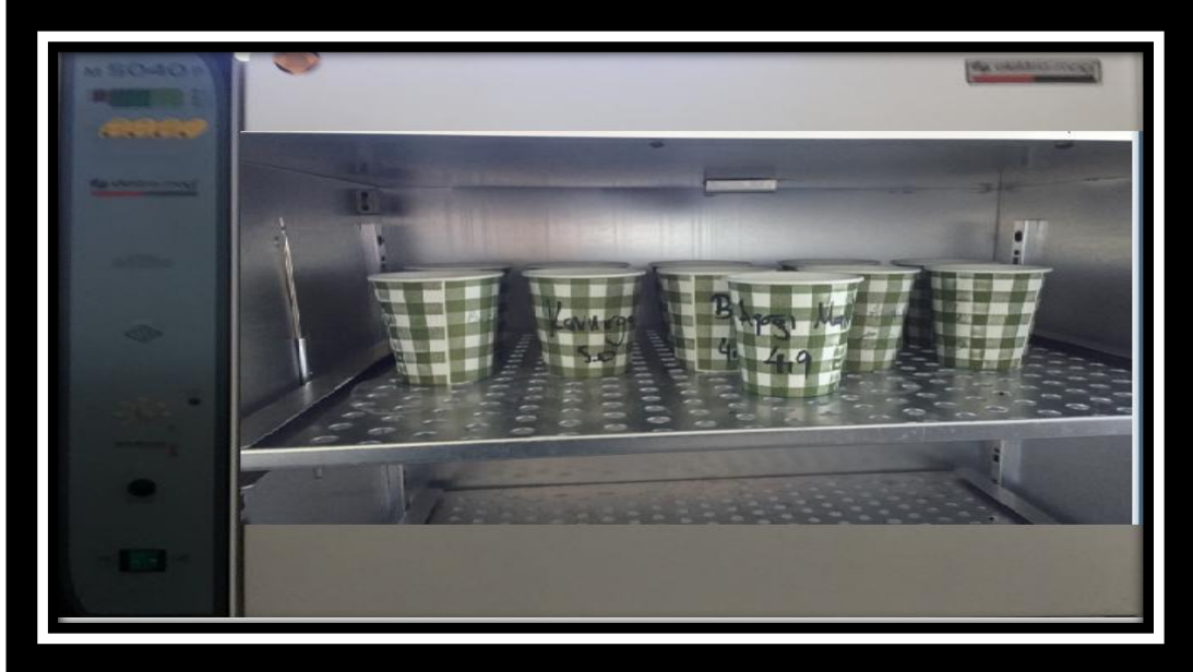
Şekil 3.9. Numunelerin etüvde nemden uzaklaştırılması
