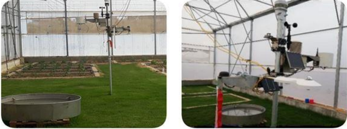
Şekil 3.3. Sera içindeki iklimsel verileri kayıt altına alan otomatik meteoroloji istasyonu
