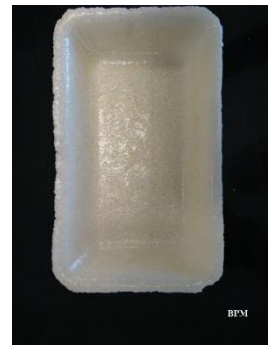
Şekil 7.1. Farklı malzemelerle kaplanan nişasta bazlı köpük tabakların fotoğrafları
