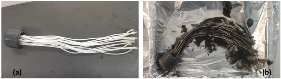
Şekil 3.6. Hollow fiber PVDF membran; a) Temiz membran; b) Kirli membran
