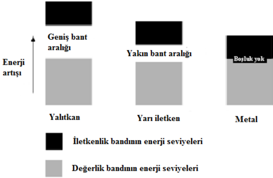
Şekil 1.2 Yalıtkanlar, yarı iletkenler ve metaller arasındaki iletkenlik farkını açıklayan bant teorisinin basit bir gösterimi
