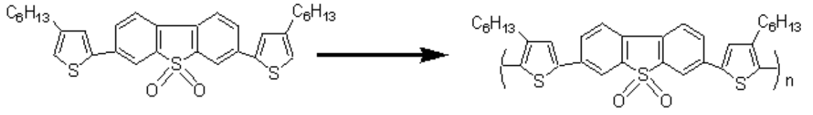
Şekil 2.8 THSO 2 'nin polimerizasyonunun şematik gösterimi
