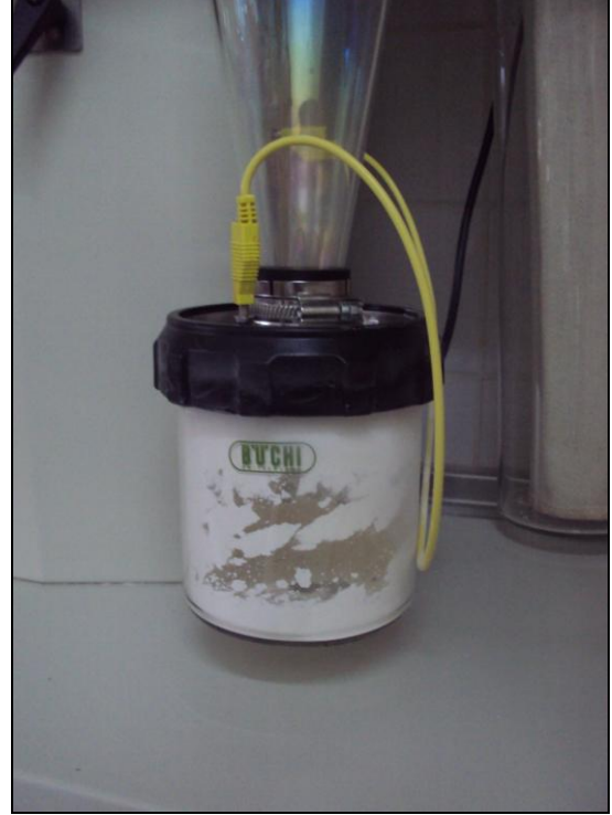
Şekil 3.4. Püskürterek kurutmada elde edilen mikrokapsüller
