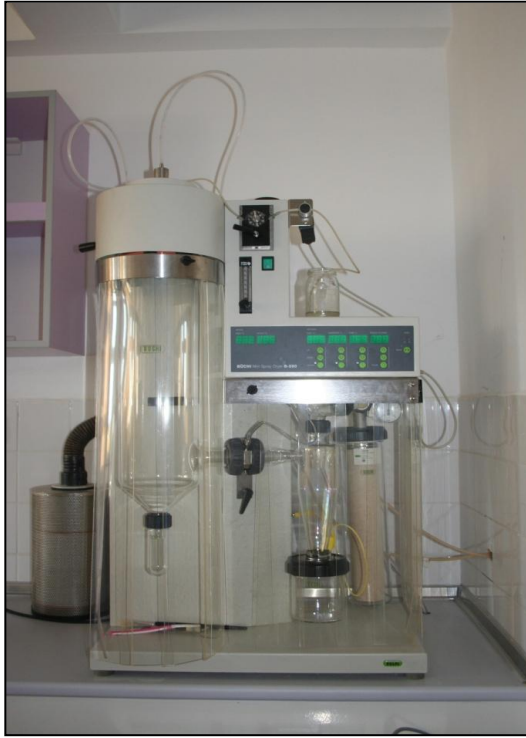
Şekil 3.3. Püskürterek kurutma sistemi
