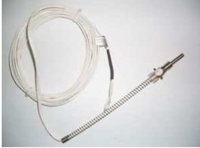
Şekil 3. 18. PT 100 sıcaklık duyargası
