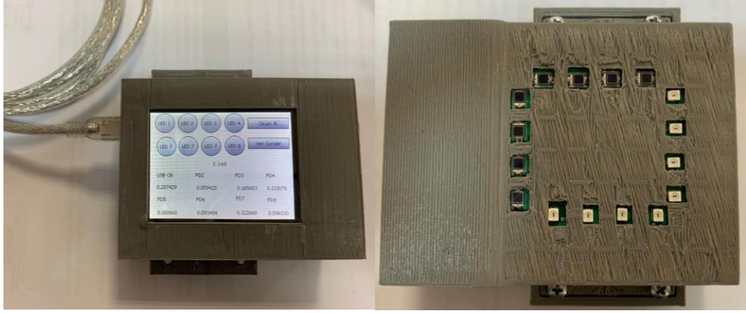
Şekil 3.6. Tasarlanan optik prob sisteminin solda ekran görüntüsü sağda ise ölçüm alınan yüzey görüntüsü.
