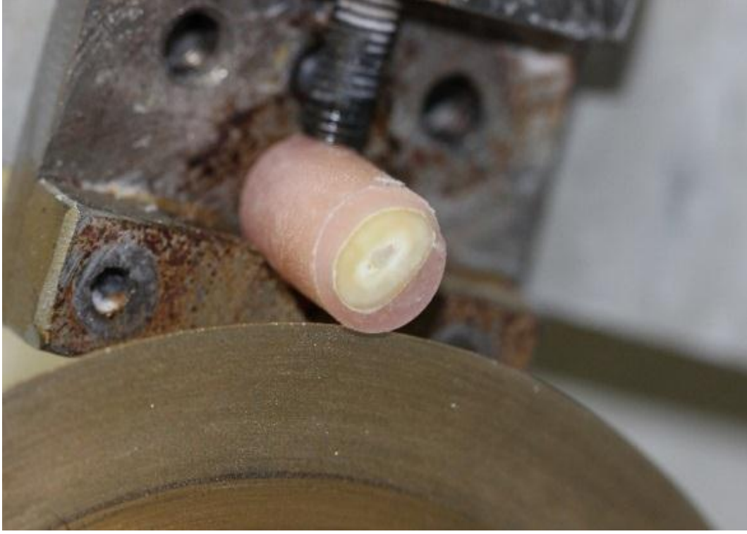
Şekil 3.17. Örneklerin 1 mm kalınlığında kesimi.
