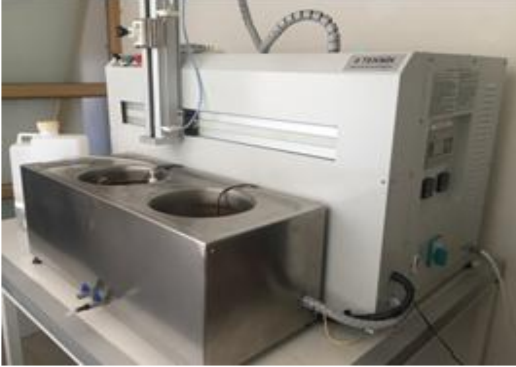
Şekil 3.15. Termal döngü cihazında örneklerin yaşlandırılması işlemi.
