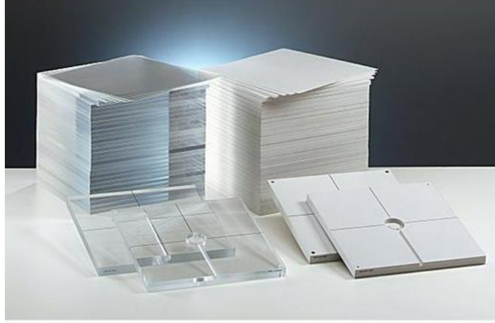
Şekil 2.11. RW3 katı fantom ( http://www.meditel.com.tr/urunler/radyoterapi-diger-urunler/radyo-terapi/ptw/fantom/ ).
