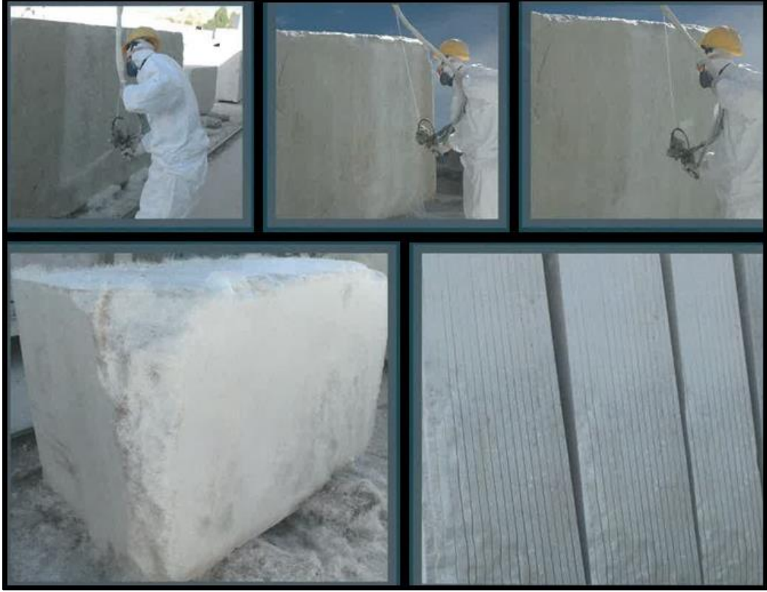
Şekil 2. 17. Polyester reçinesinin mermer bloğuna uygulanışı ve kesim sonucu ortaya çıkan mermer levhalarının görünümü
