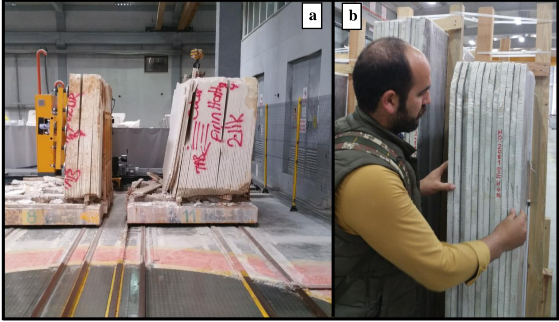
Şekil 3. 15. Mermer bloğun kesiminde oluşan kırılma ve çatlakların sonucunda ortaya çıkan levha kayıplarının görünümü; a) Mermer bloğuna polyester reçinesi uygulanmamış hali; b) Mermer bloğuna polyester reçinesi uygulanmış hali
