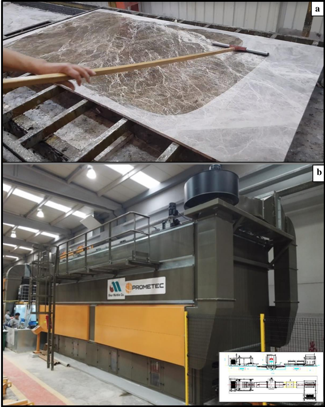
Şekil 3. 11. Mermer levhasının yüzeyine epoksi reçinesinin sürülmesi ve mermer levhasının kürlenmesi (pişirme) için tekrar fırınlara gönderilerek bekletilmesindeki fabrika görünümü; a) Mermer levhasının yüzeyine sürülen epoksi reçinesi; b) Mermer levhasının yüzeyine sürülen epoksi reçinelerin pişirme fırını
