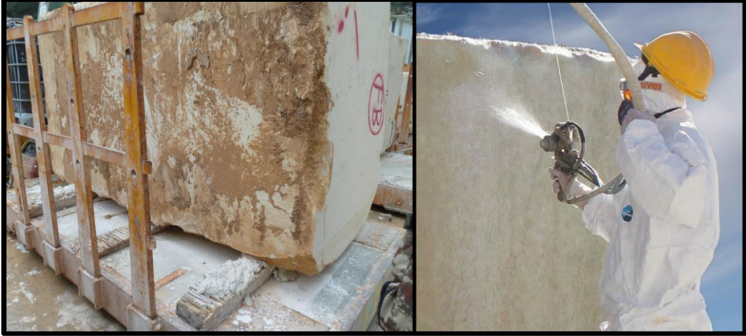
Şekil 3. 13. Mermer bloğuna püskürterek uygulanan polyester reçinesi uygulaması (Yücel kompozit firması 2019)
