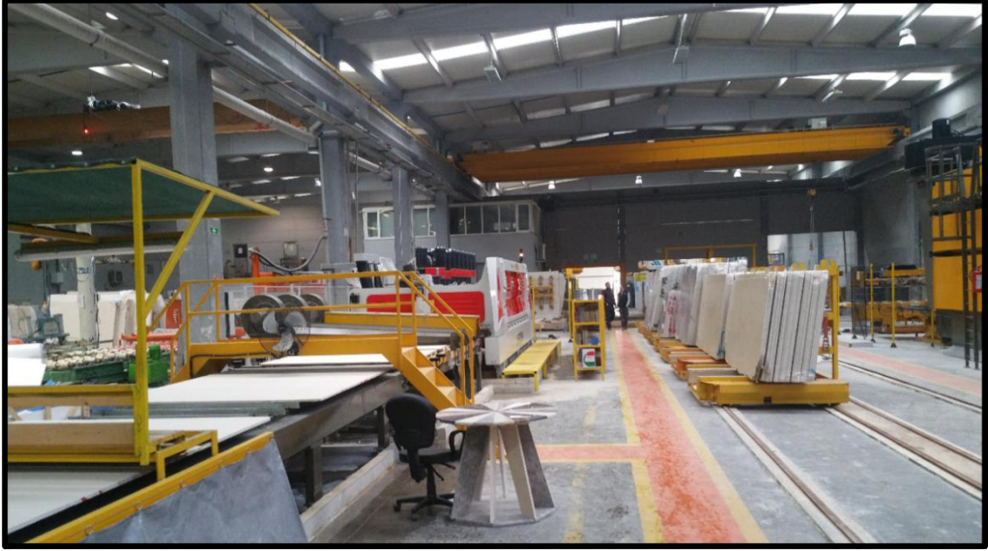
Şekil 3. 12. Epoksi işlemi biten mermer levhaları kuruduktan sonra istenilen boyutlarda ve alınan siparişe göre kesilmek üzere stok alanına götürülme bölümü
