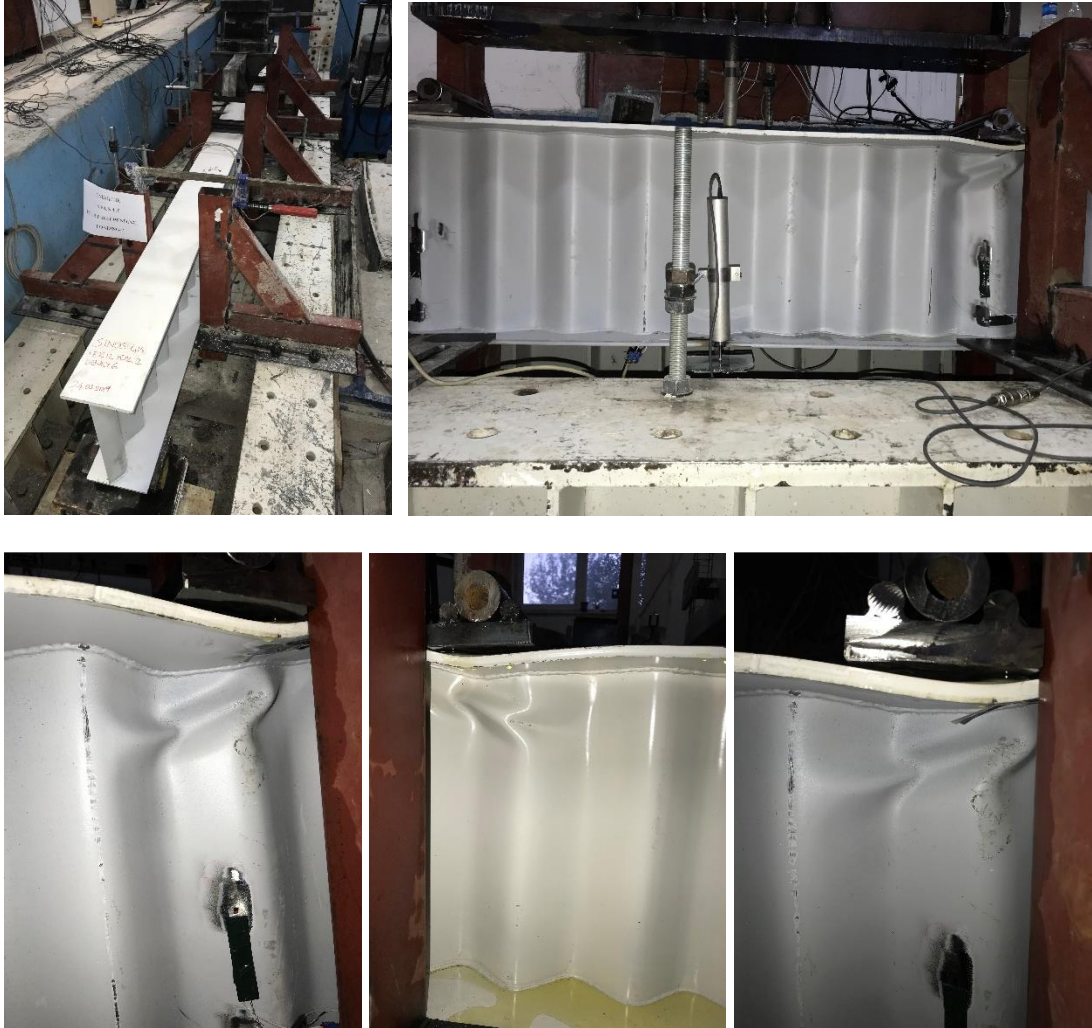
Şekil 4.21. SGOK_415 Test_2; iki noktalı yükleme altında göçme durumları
