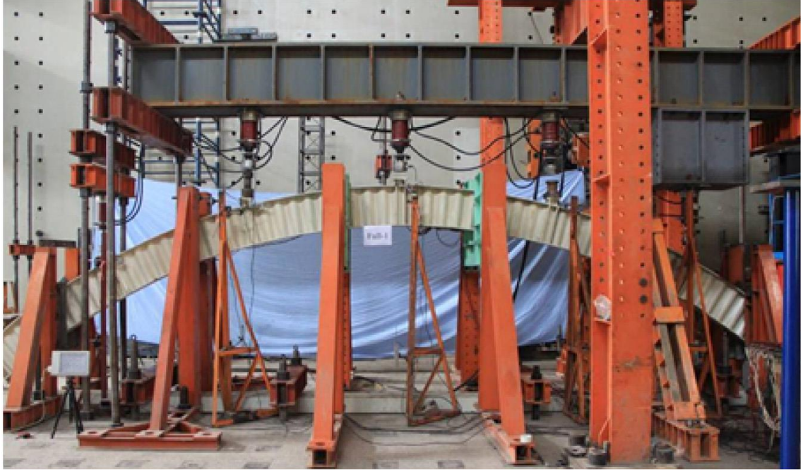
Şekil 2.16. Guo vd. (2016) kemer test düzeneği
