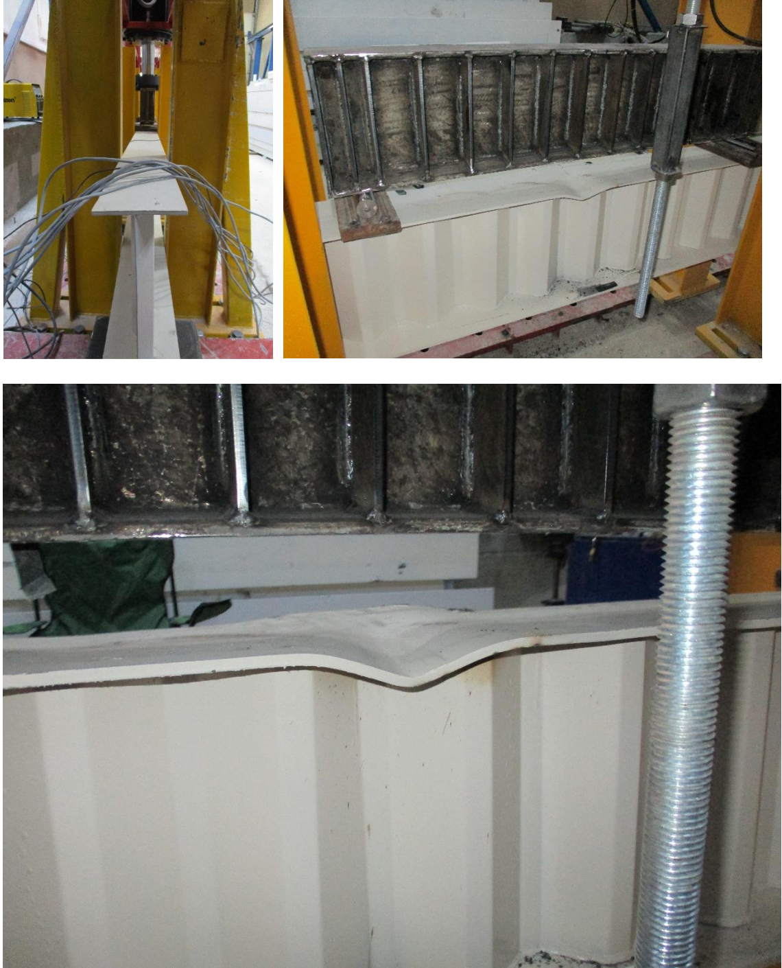
Şekil 4.51. TGOK_330 Test_2; iki noktalı yükleme altında göçme durumları
