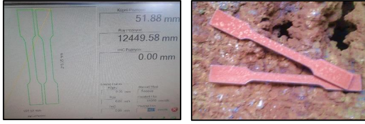
Şekil 3.25. Ondülin gövdeli kirişlerden alınan numune örnekleri
