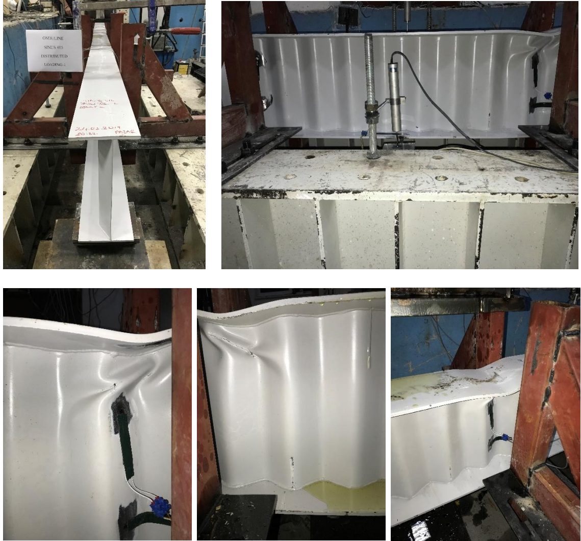
Şekil 4.6. SGOK_415 Test_1; yayılı yükleme altında göçme durumları
