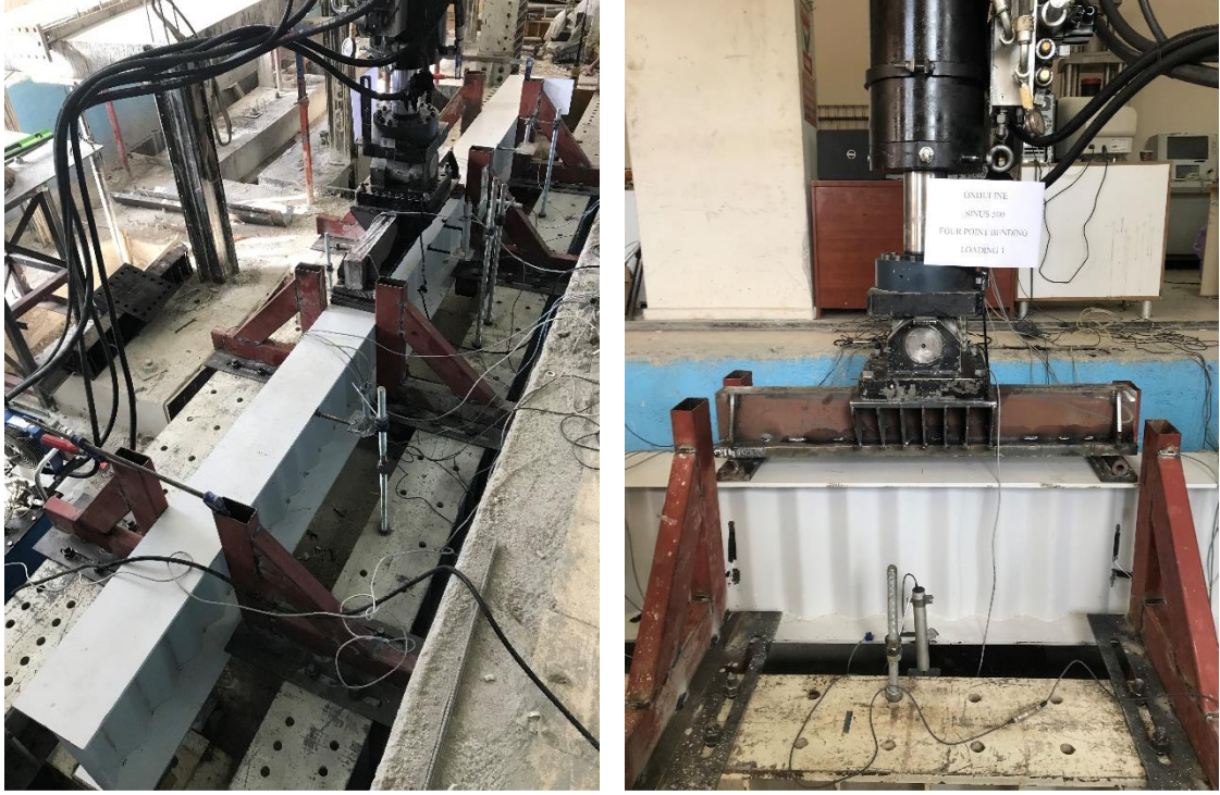
Şekil 4.14. Sinusoidal gövdeli ondülin kiriş testi; yayılı yükleme durumu
