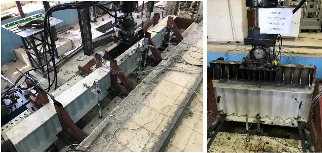
Şekil 4.27. Trapezoidal gövdeli ondülin kiriş testi; yayılı yüklenme durumu
