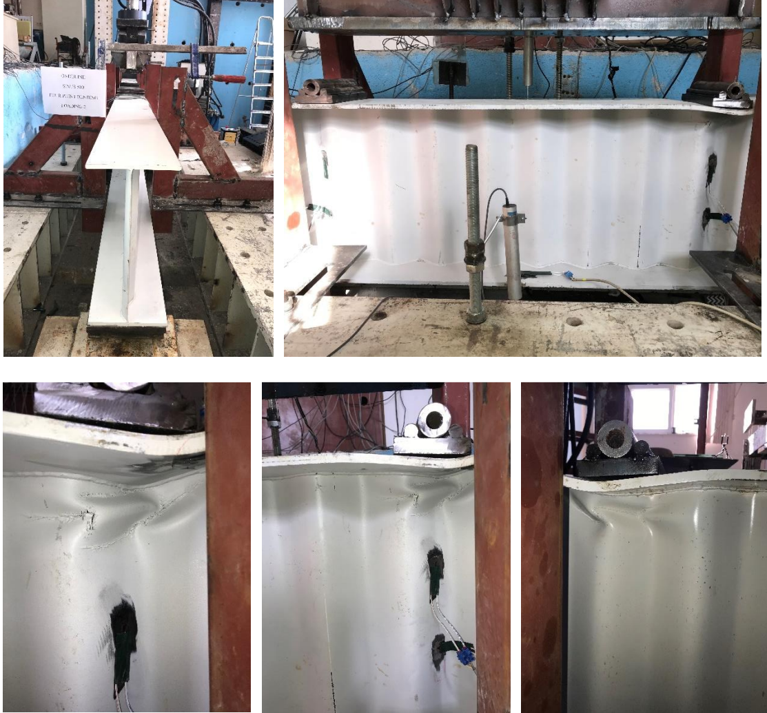
Şekil 4.17. SGOK_500 Test_2; iki noktalı yükleme altında göçme durumları
