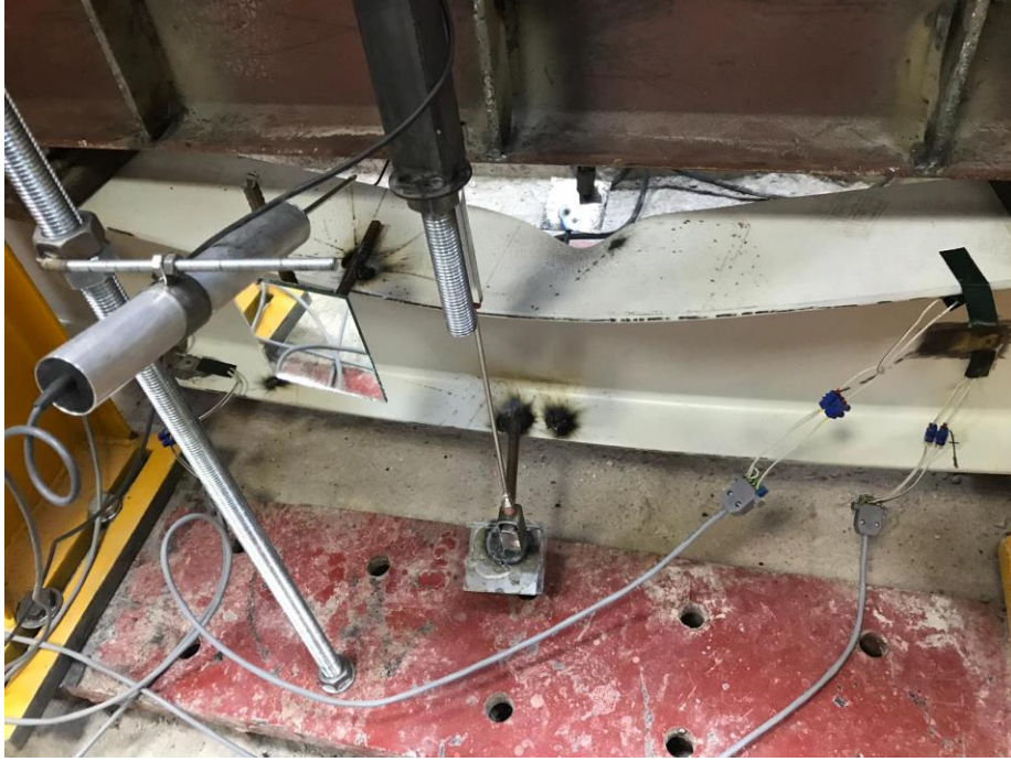
Şekil 4.54. IPE 300 deney elemanının deformasyon sonucu
