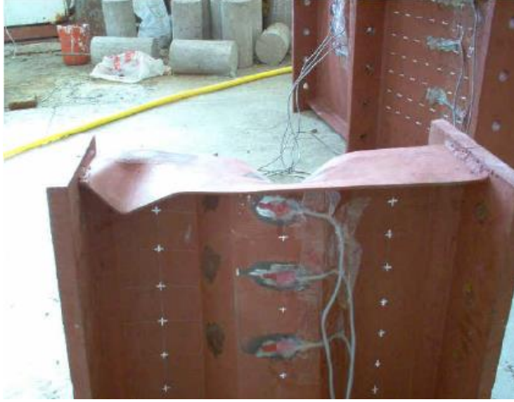
Şekil 2.25. Deformasyona uğramış kiriş test numunesi
