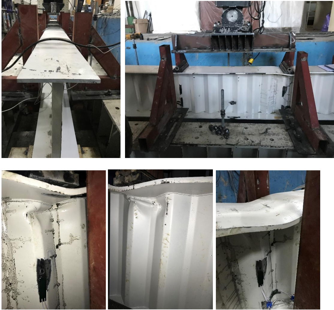
Şekil 4.41. TGOK_500 Test_1; iki noktalı yükleme altında göçme durumları
