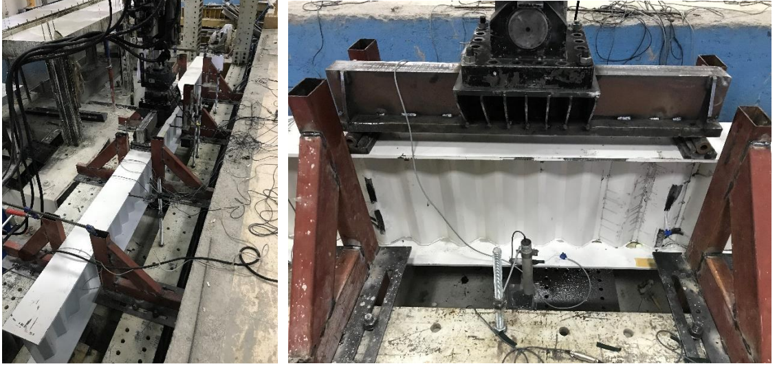
Şekil 4.40. Trapezoidal gövdeli ondülin kiriş testi; yayılı yükleme durumu
