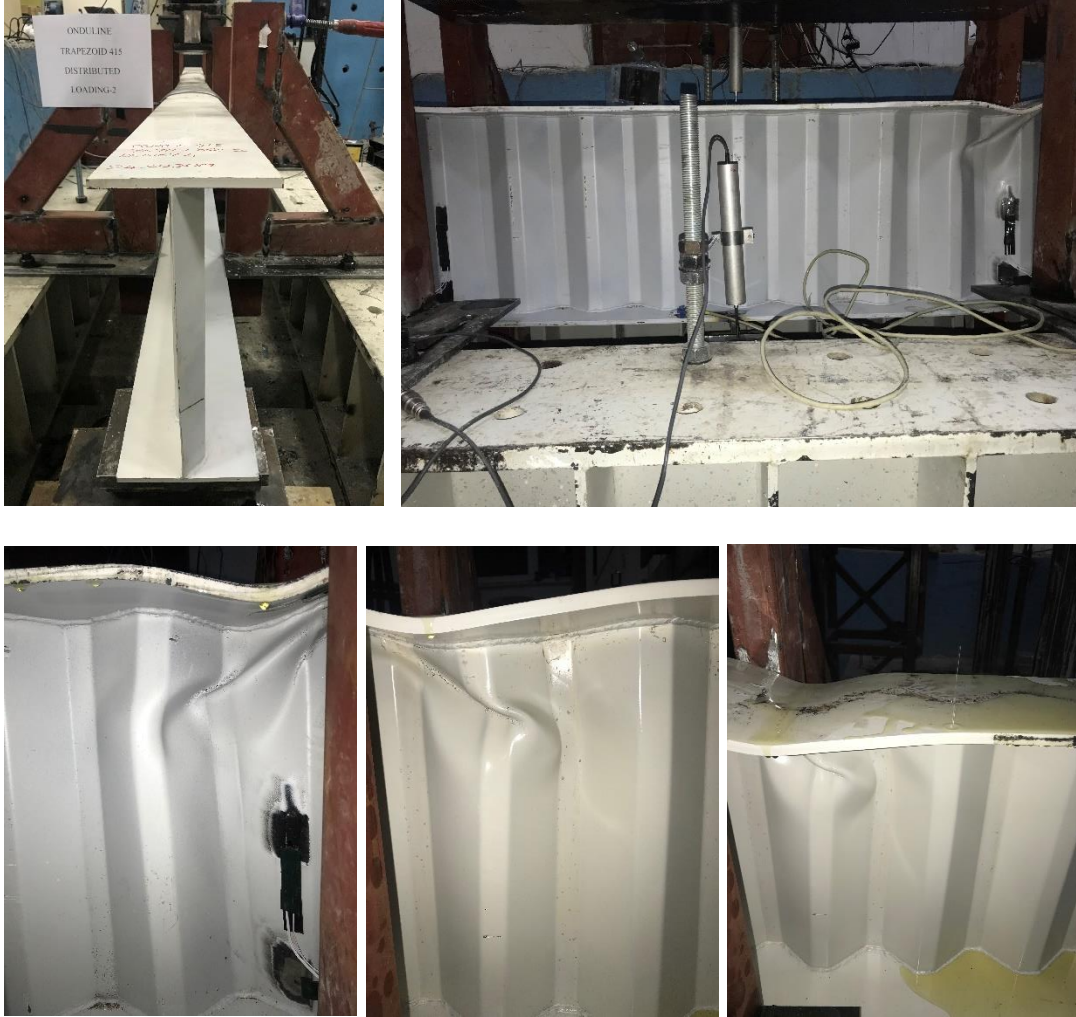
Şekil 4.34. TGOK_415 Test_2; yayılı yükleme altında göçme durumları
