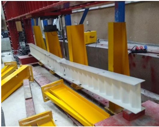
Şekil 2.36. Basit eğilme (SGOK_330 İki Noktalı Yükleme Deney Fotoğrafi 2019)
