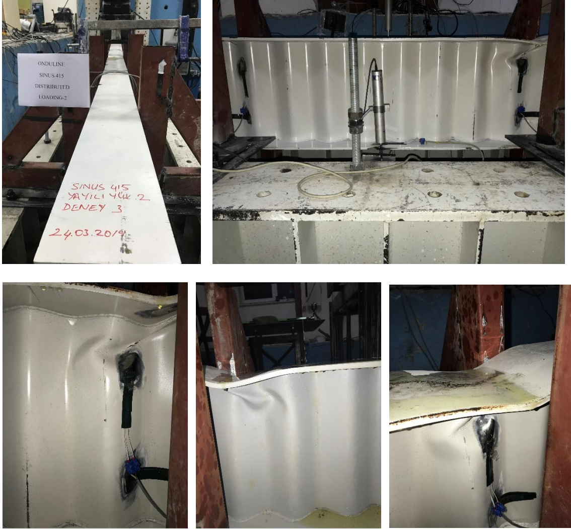
Şekil 4.8. SGOK_415 Test_2; yayılı yükleme altında göçme durumları
