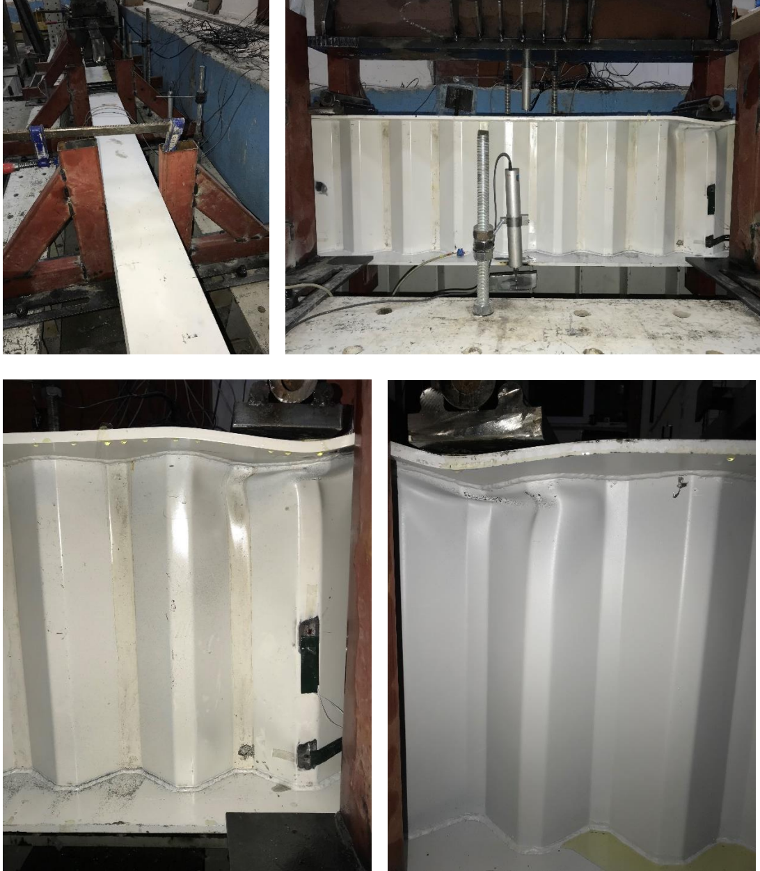
Şekil 4.47. TGOK_415 Test_2; iki noktalı yükleme altında göçme durumları
