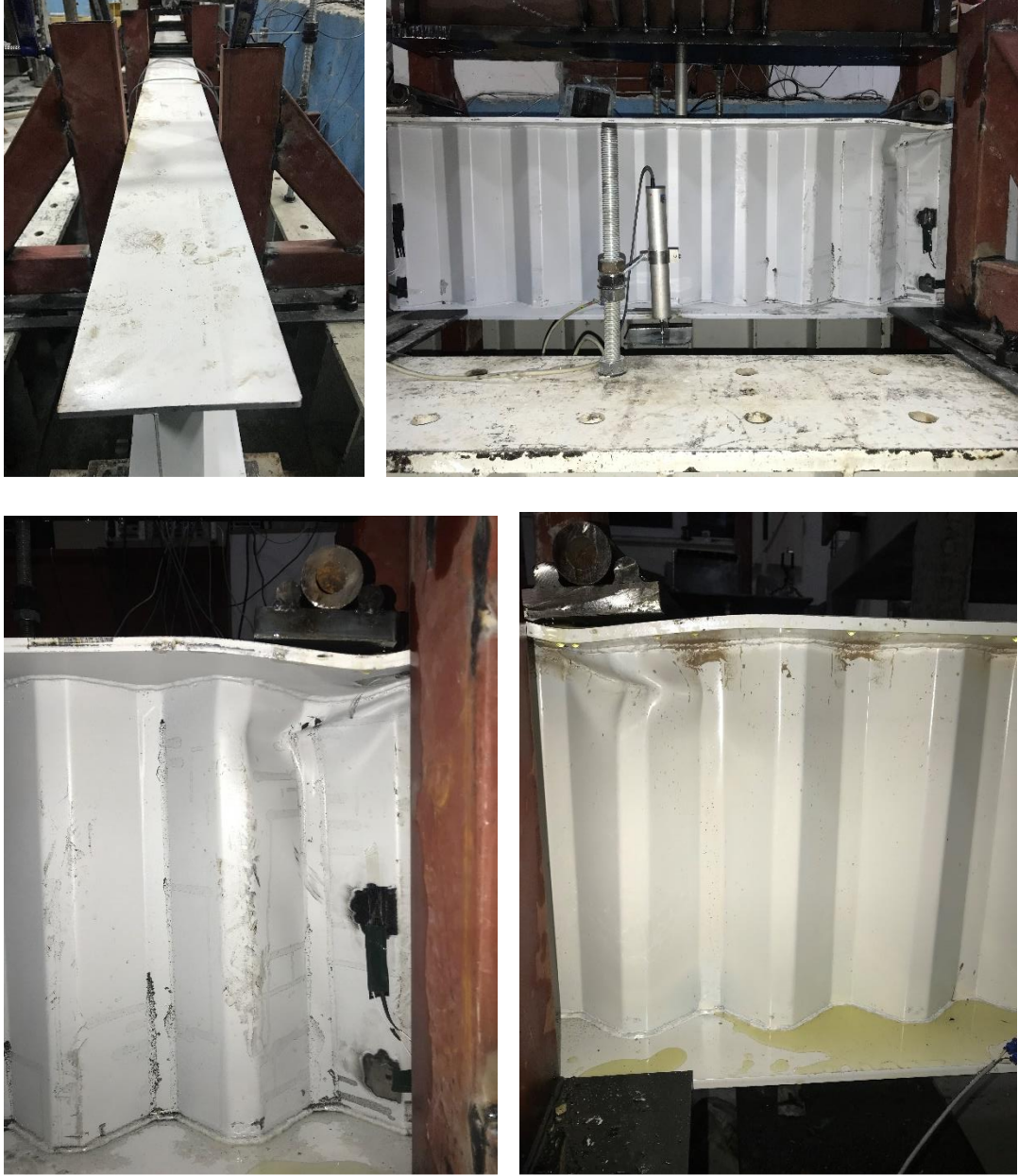
Şekil 4.45. TGOK_415 Test_1; iki noktalı yükleme altında göçme durumları
