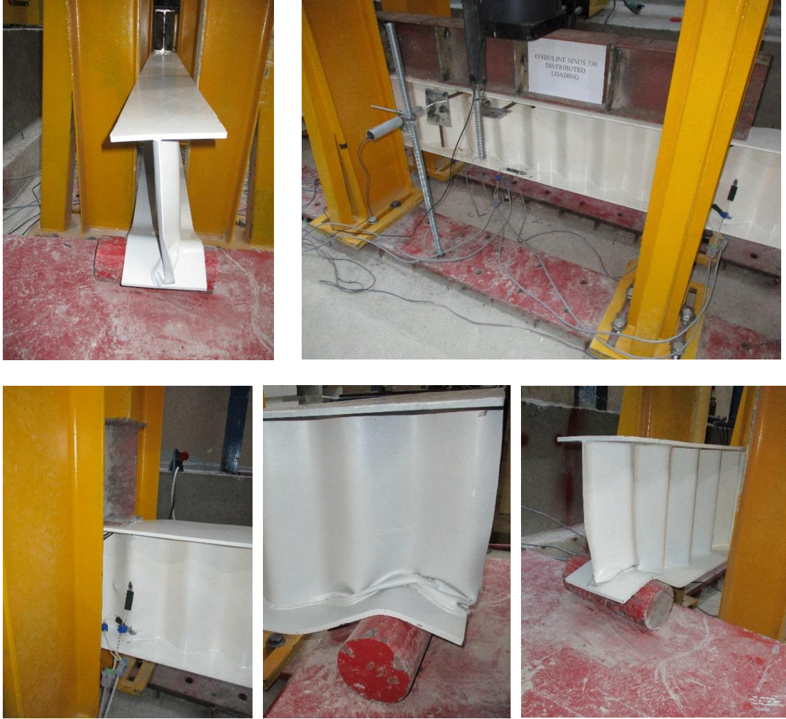
Şekil 4.10. SGOK_330 Test_1; yayılı yükleme altında göçme durumları
