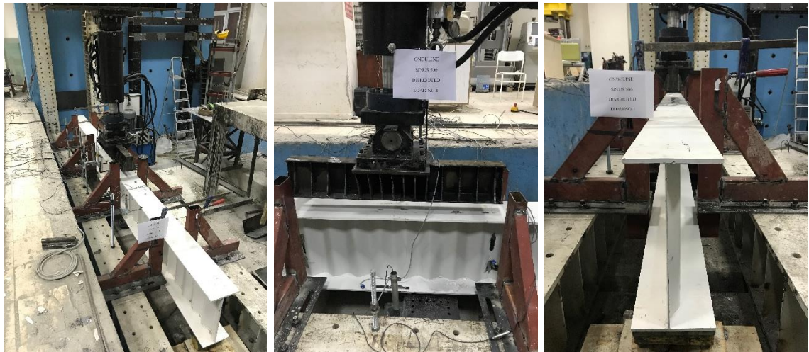
Şekil 4.1. Sinusoidal gövdeli ondülin kiriş testi; yayıllı yükleme durumu
