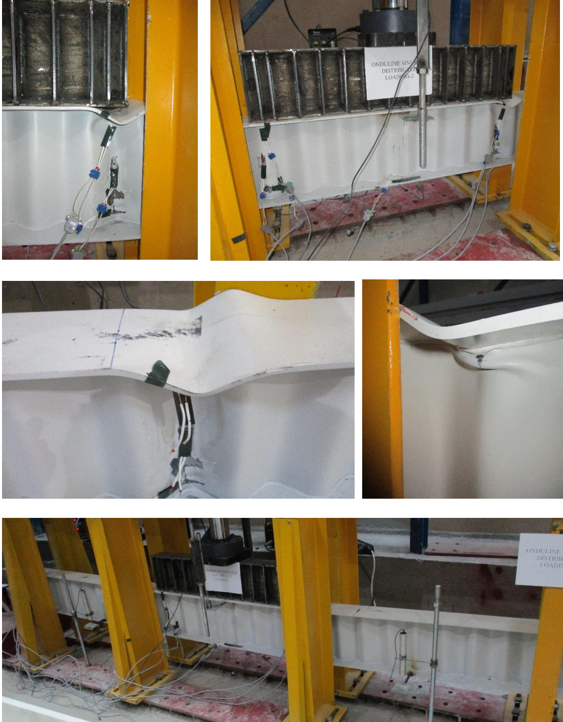
Şekil 4.12. SGOK_330 Test_2; yayılı yükleme altında göçme durumları
