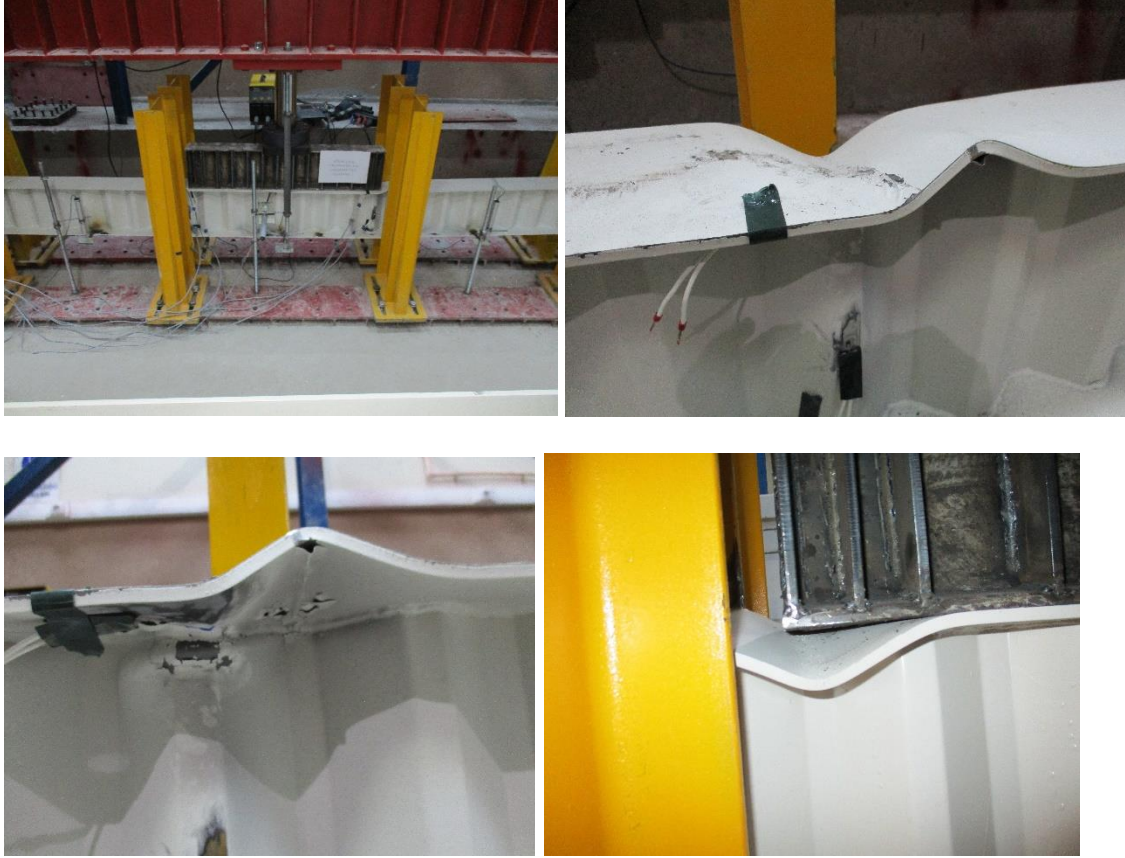
Şekil 4.36. TGOK_330 Test_1; yayılı yüklemeye altında göçme durumları
