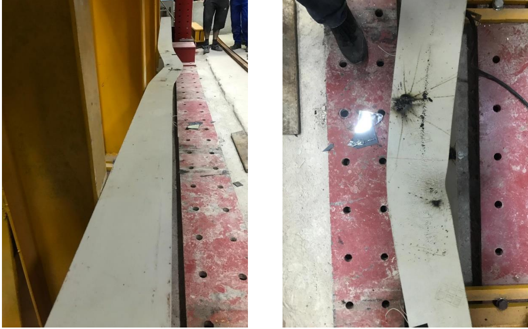
Şekil 2.34. İkincil eğilme (SGOK_330 İki Noktalı Yükleme Deney Fotoğrafı 2019)
