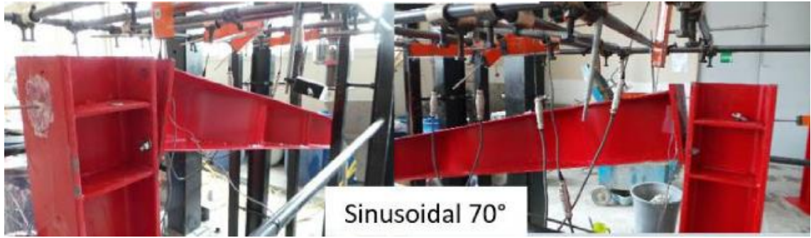
Şekil 2.12. Sinüzoidal gövdeli kirişin deney sonrası göçme durumu ve bulonları
