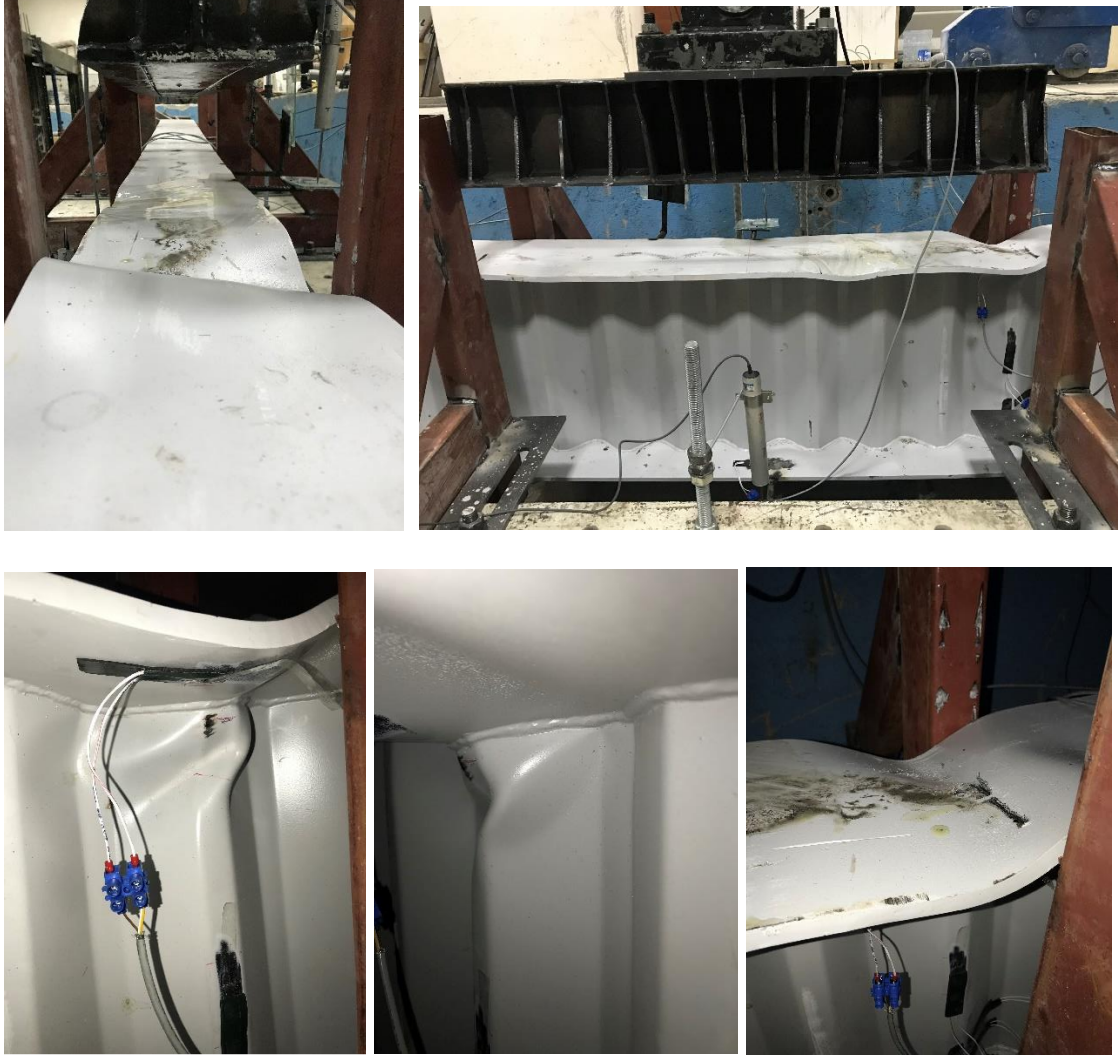
Şekil 4.30. TGOK_500 Test_2; yayılı yüklemeye altında göçme durumları
