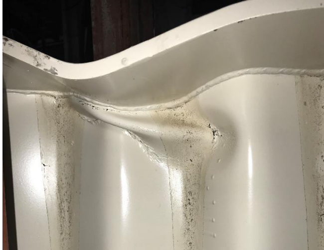
Şekil 4.65. SGOK_500 Yayılı yüklem altında gövde ve başlıkta deneysel deformasyon sonucu
