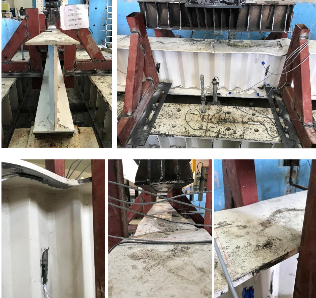
Şekil 4.28. TGOK_500 Test_1; yayılı yükleme altında göçme durumları
