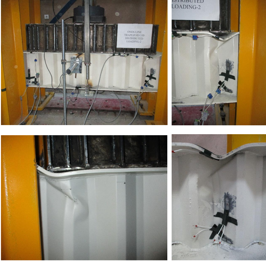
Şekil 4.38. TGOK_330 Test_2; yayılı yükleme altında göçme durumları
