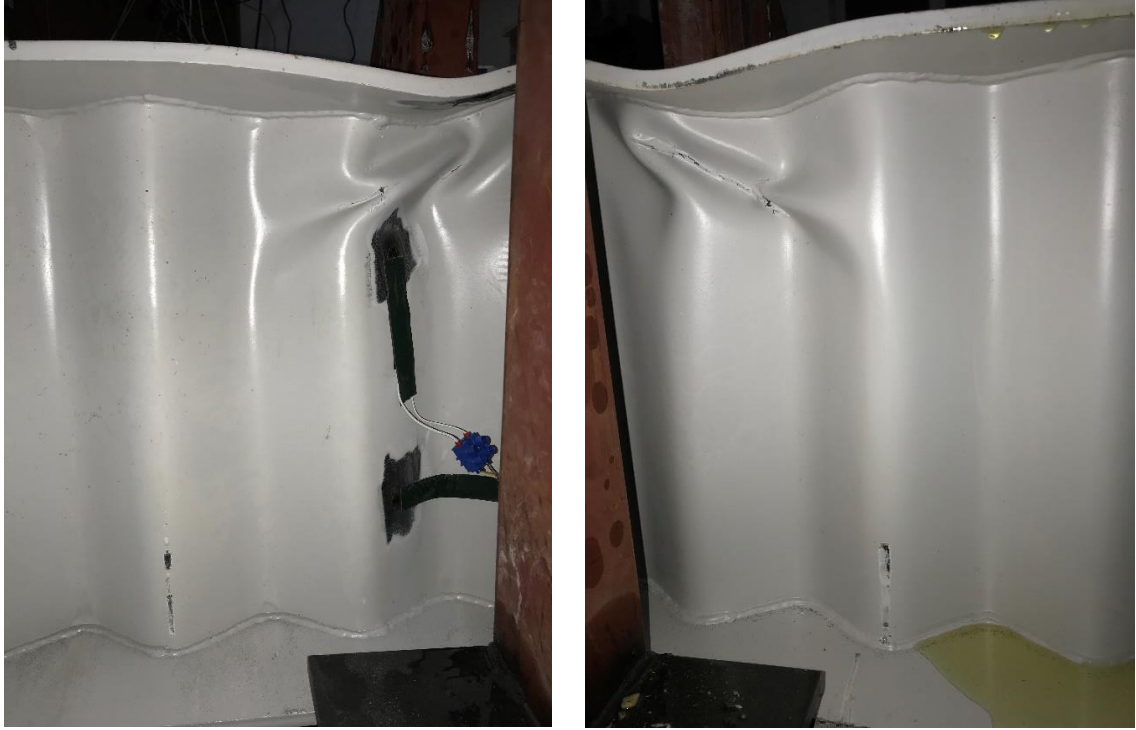
Şekil 2.35. Gövdede burkulma (SGOK_415 Yayılı Yükleme Deney Fotoğrafi 2019)
