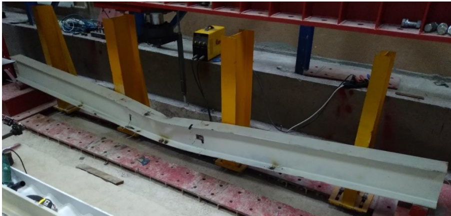
Şekil 4.53. IPE 300 deney elemanının deformasyon sonucu
