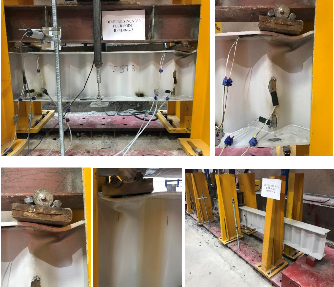
Şekil 4.25. SGOK_330 Test_2; iki noktalı yükleme altında göçme durumları
