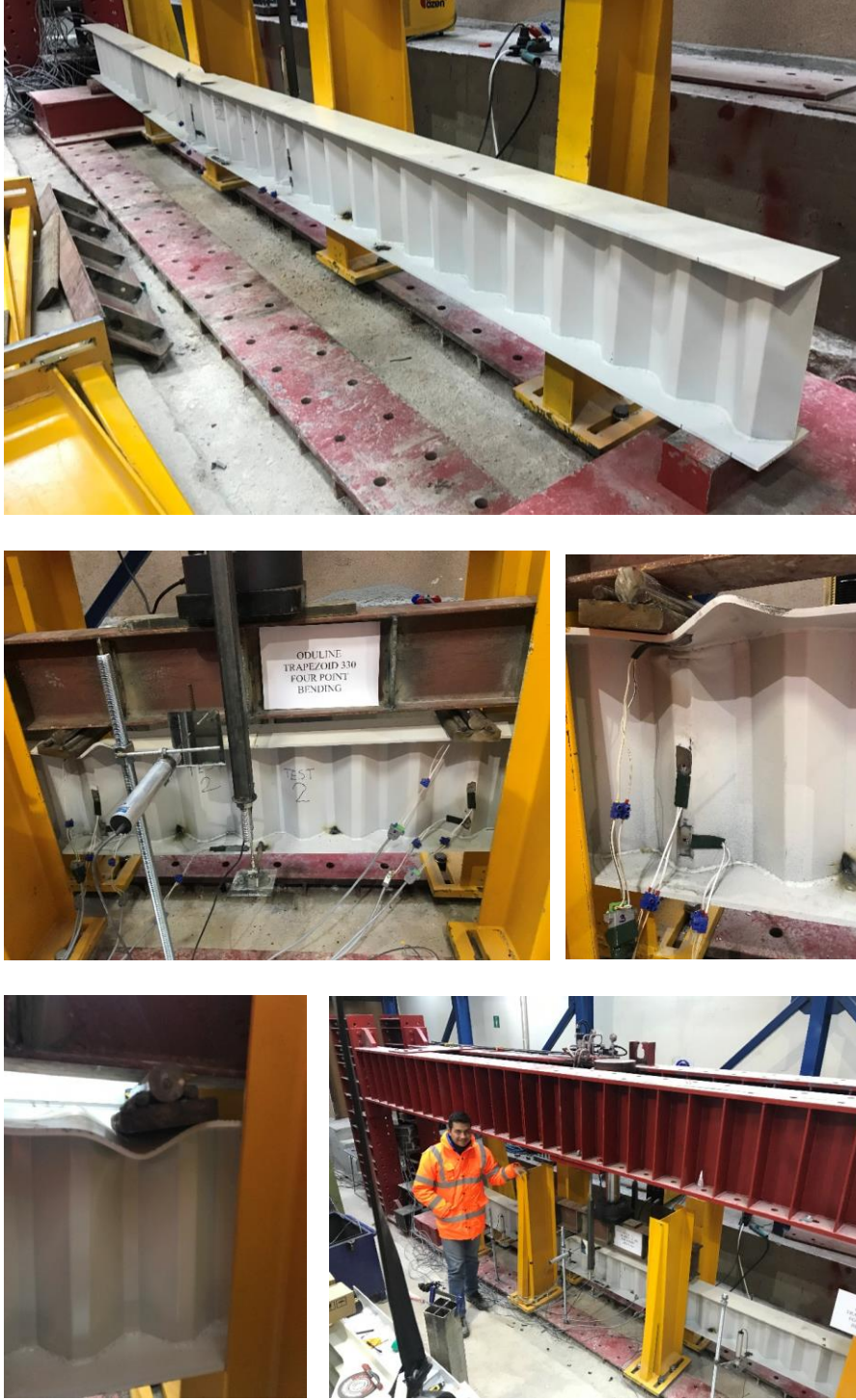
Şekil 4.49. TGOK_330 Test_1; iki noktalı yükleme altında göçme durumları
