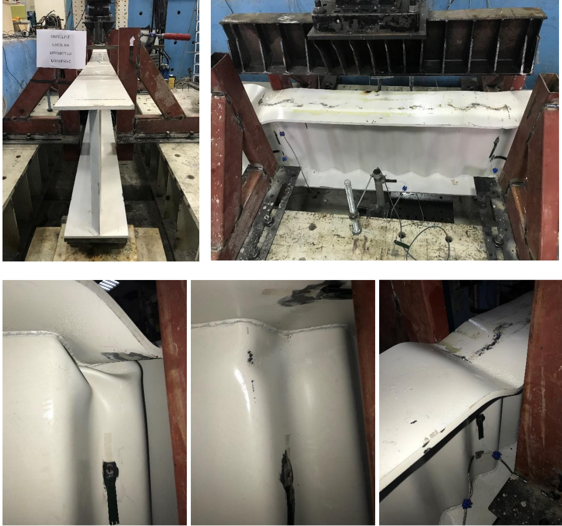
Şekil 4.4. SGOK_500 Test_2; yayılı yükleme altında göçme durumları
