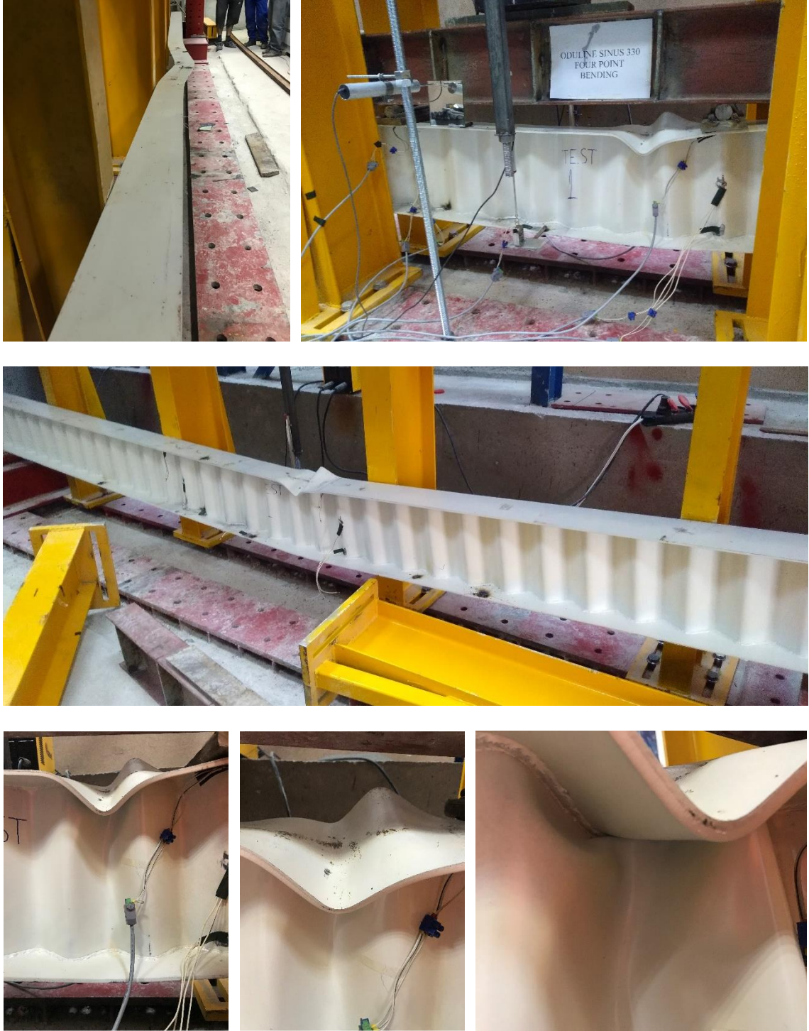
Şekil 4.23. SGOK_330 Test_1; iki noktalı yükleme altında göçme durumları
