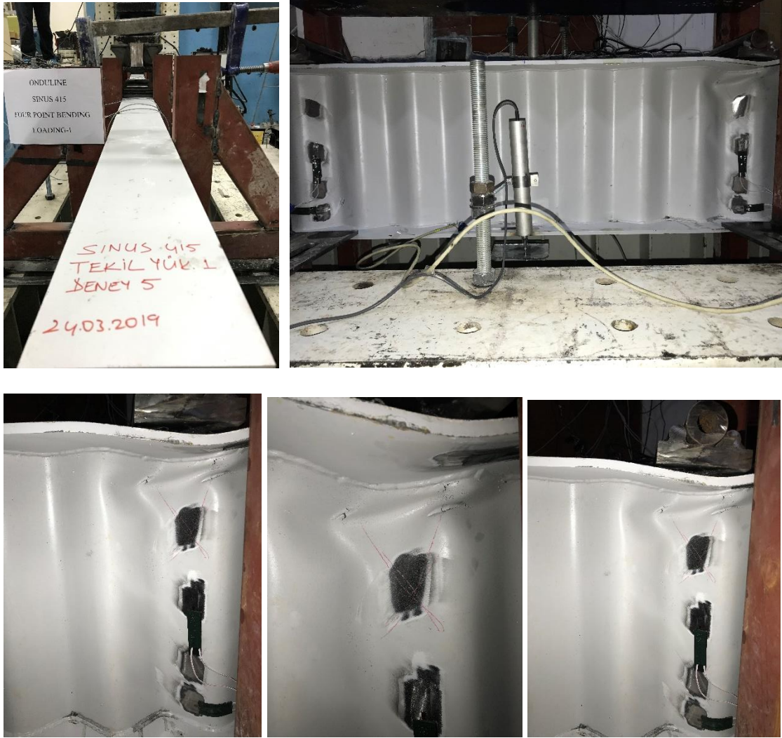
Şekil 4.19. SGOK_415 Test_1; iki noktalı yükleme altında göçme durumları
