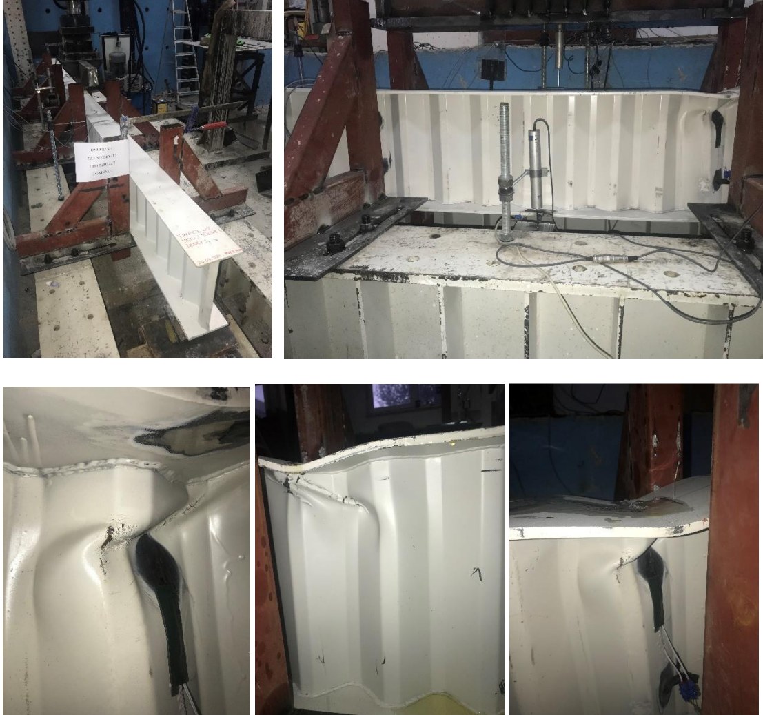
Şekil 4.32. TGOK_415 Test_1; yayılı yüklemeye altında göçme durumları
