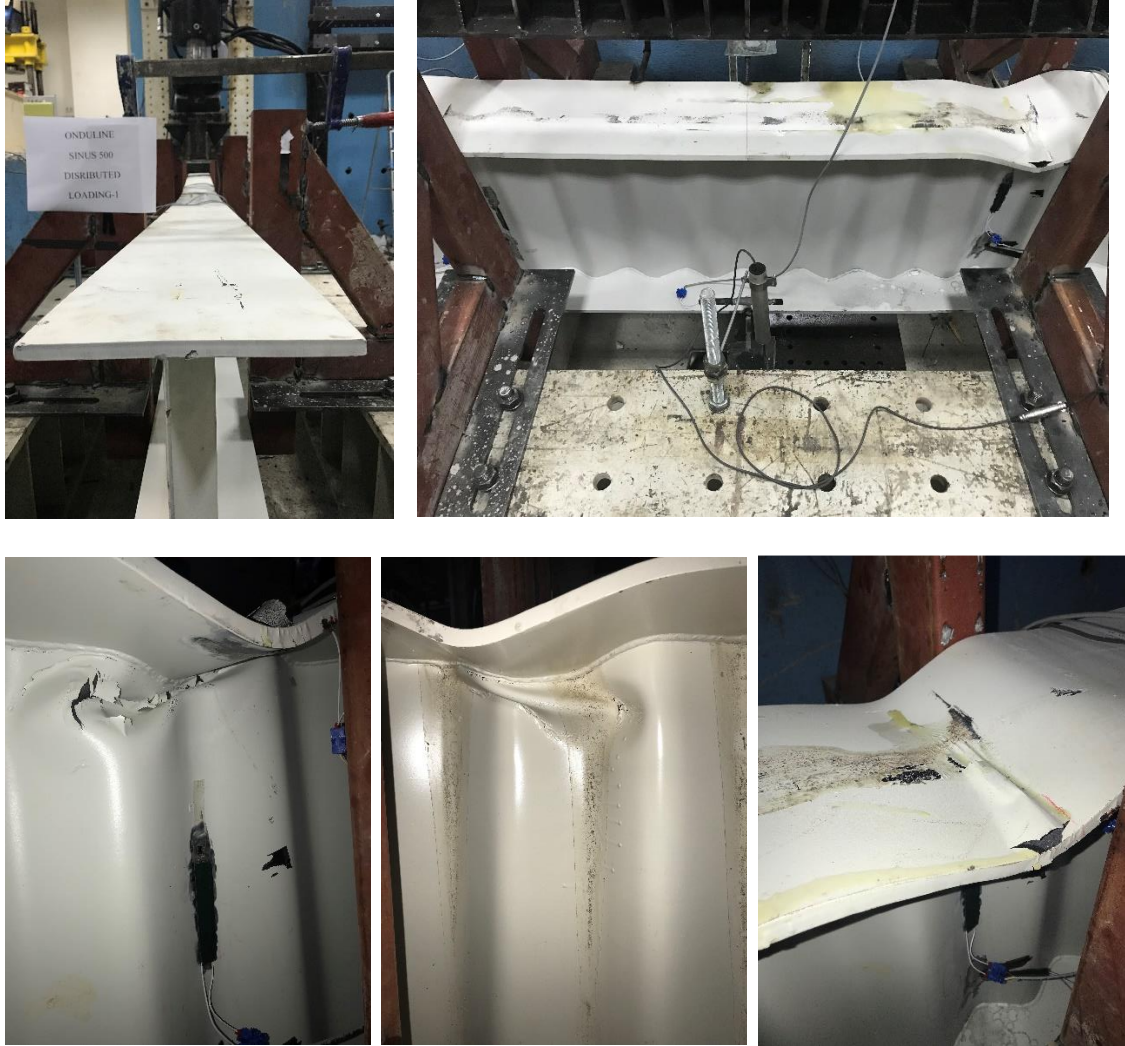
Şekil 4.2. SGOK_500 Test_1; yayılı yükleme altında göçme durumları
