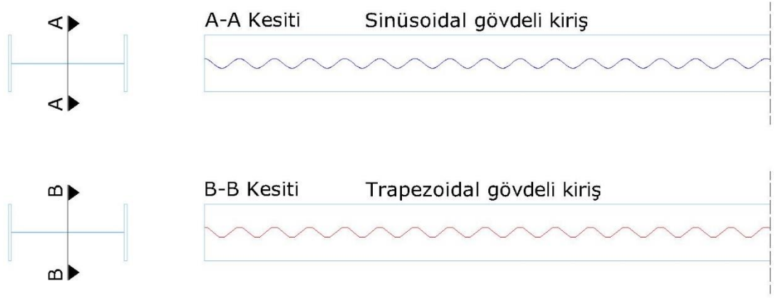
Şekil 2.30. Sinüzoidal ve Trapezoidal gövdeli çelik kirişler
