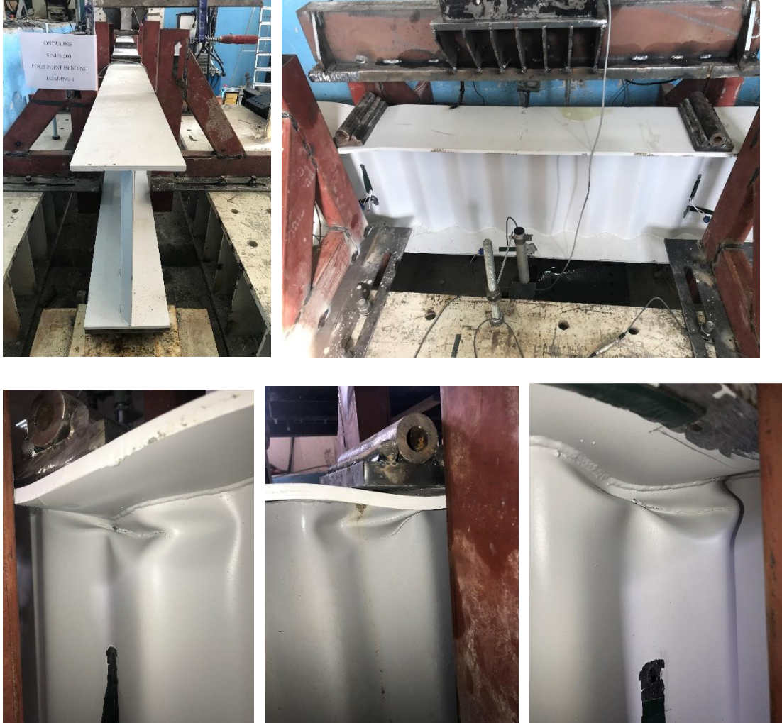
Şekil 4.15. SGOK_500 Test_1; iki noktalı yükleme altında göçme durumları
