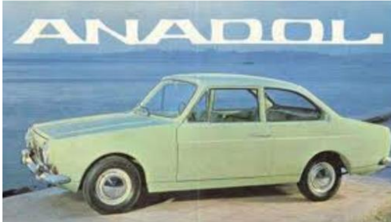
Şekil 2.1. Büyük bir bölümü kompozitten imal edilmiş araç (Pektaş 2018)
