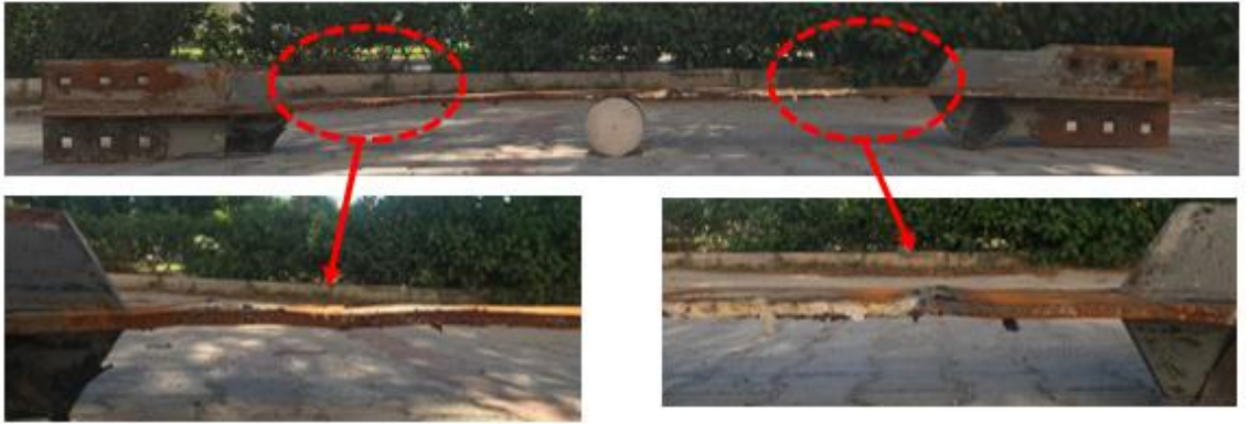
Şekil 4.19. Deney sonrası 3.BEÇÇ elemanda meydana gelen deformasyonlar
