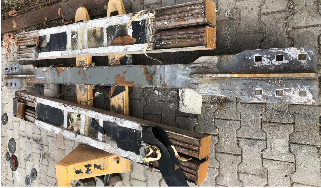
Şekil 4.13. Deney sonrası 2.BEÇÇ elemanda meydana gelen deformasyonlar
