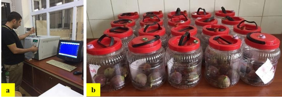
Şekil 3.13. Solunum hızı ve etilen ölçümlerinde kullanılan GC cihazı (a) ve ölçüm yapılan kapların genel görünümü (b)
