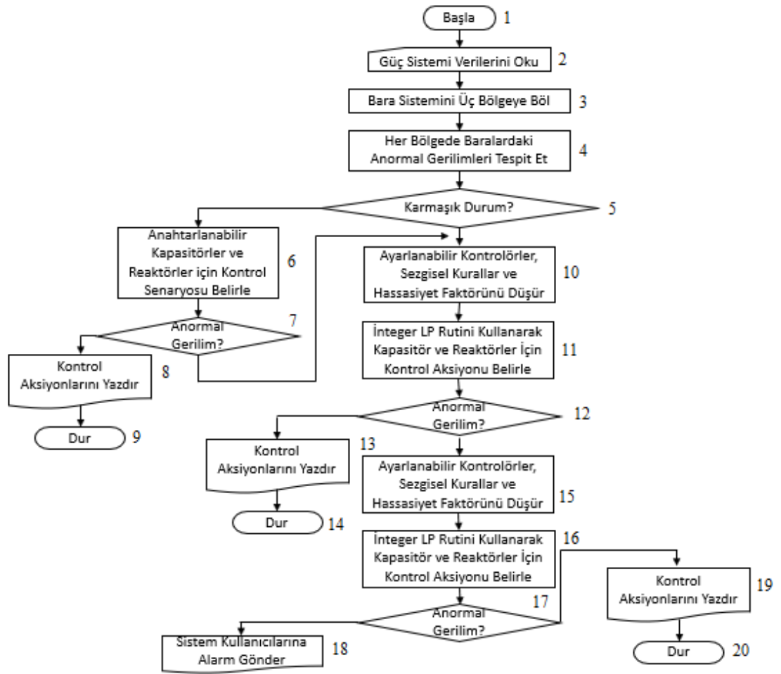
Şekil 2.5. Sonuç Motorunun Gerilim Regülasyonunu Gerçekleştirmek için Kullanılan Kontrol Algoritmasına ait Akış Şeması
