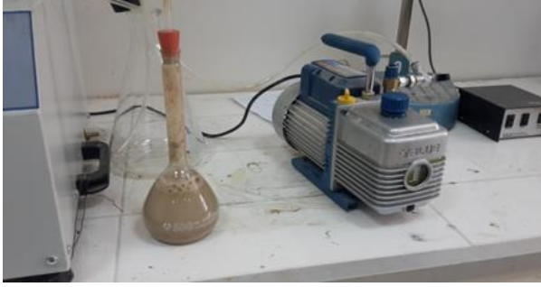
Şekil 3.2. Vakumlu Desikatör Aracılığıyla Havanın Alınması
