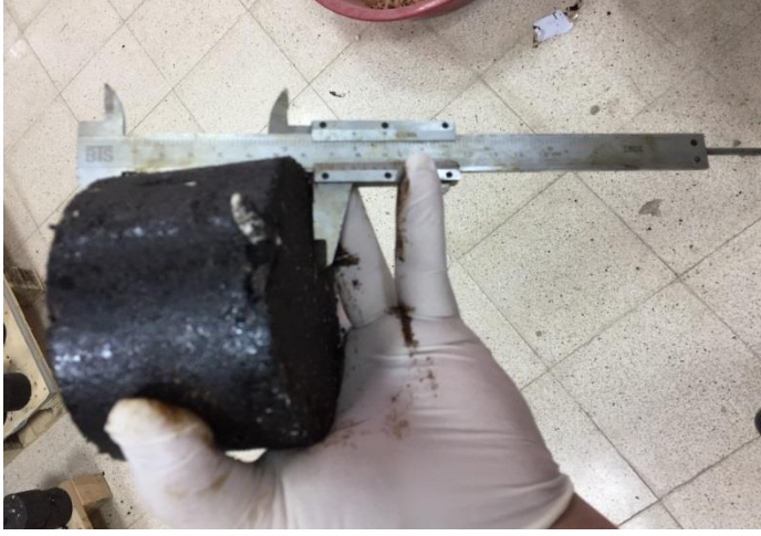
Şekil 4.8. Numunelerin Yksekliklerinin llmesi
