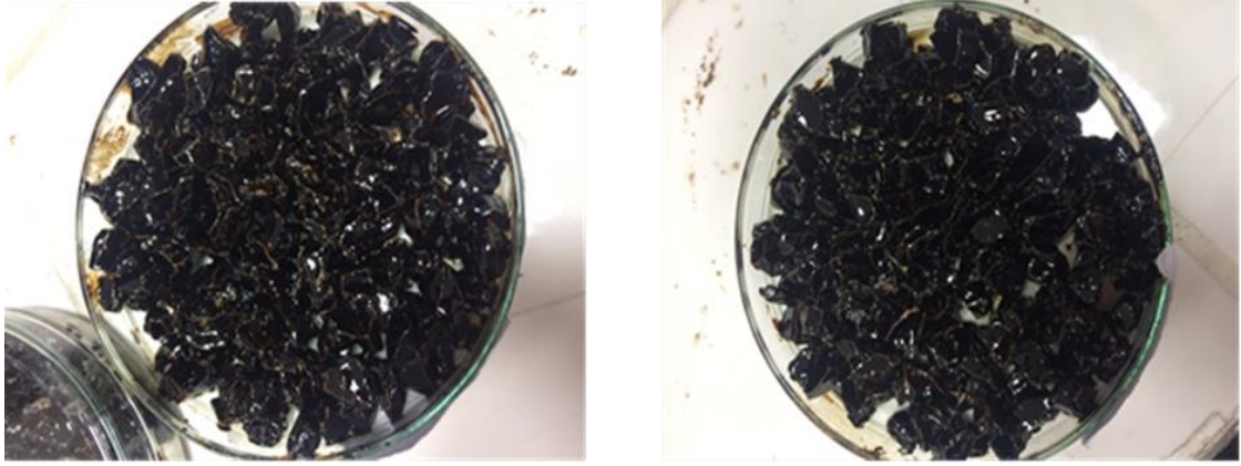
Şekil 3.11. Normal Agregası Soyulma Durumu
