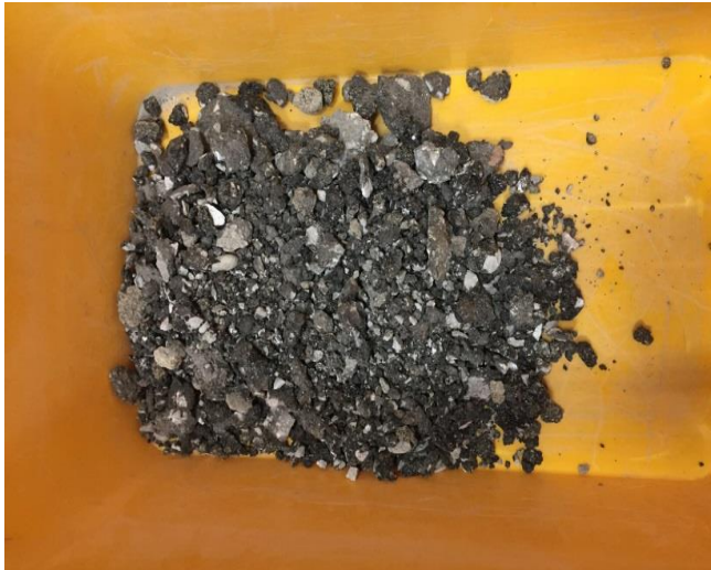
Şekil 3.6. Sahadan Kazınmış Asfalt
