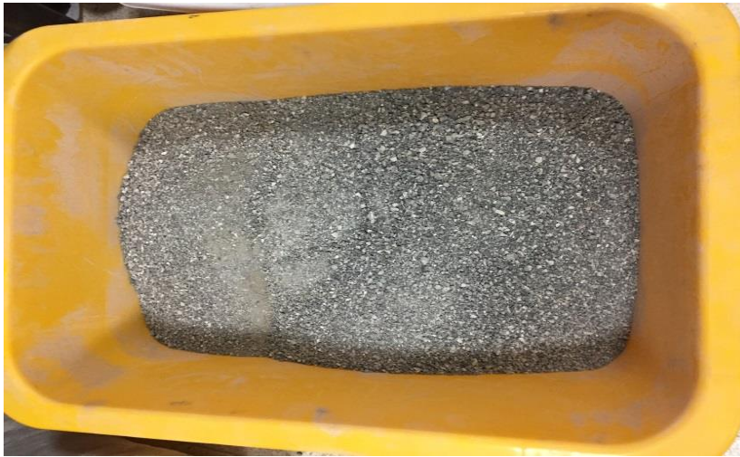
Şekil 3.8. Konkasörde Kırıldıktan Sonra Kazınmış Asfalt
