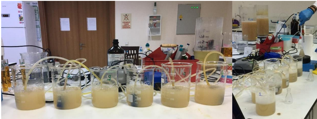
Şekil 3.2. Aktif çamur inhibisyon deney düzeneği
