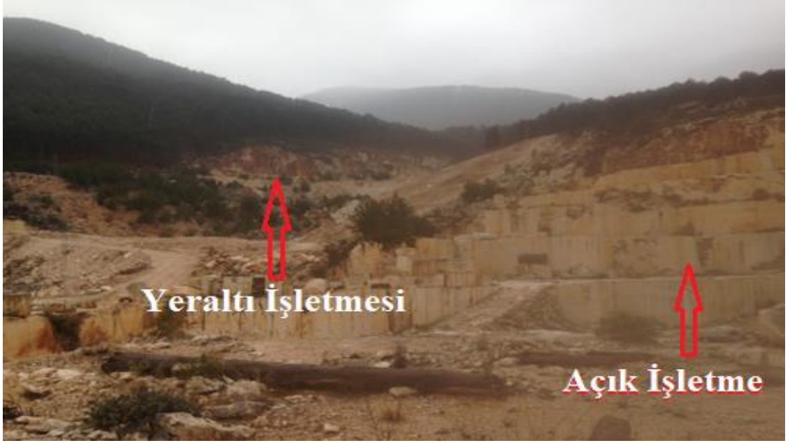
Şekil 1.5. Çalışma alanında daha önce yapılmış olan ve terk edilmiş açık işletme ve yeraltı işletmesinin yapıldığını gösteren fotoğraf
