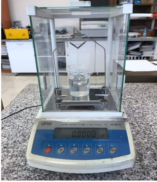
Şekil 3.7. Arşimet yöntemi ile yoğunluk ölçümü mekanizması
