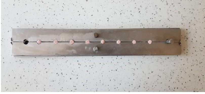
Şekil 3.2.1. Porselen uygulamasında kullanılan metal kalıp
