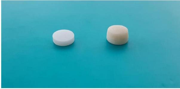
Şekil 3.2.4. 1,5 mm kalınlığındaki zirkonya altyapı ve porselen örnek
