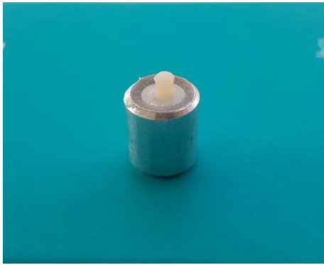
Şekil 3.5.2. Tamir malzemesi uygulanan örnek
