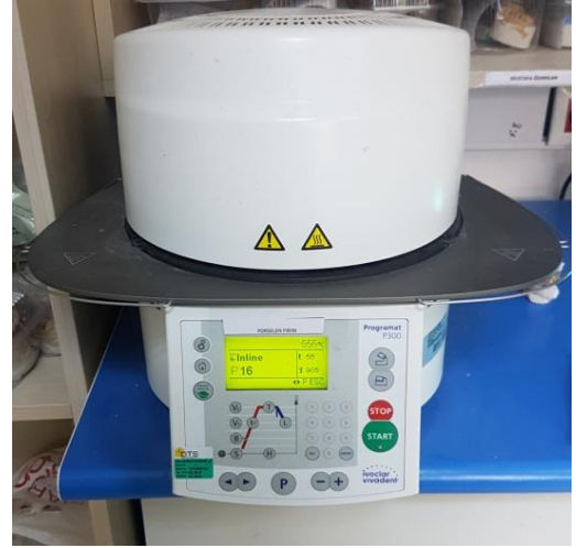
Şekil 3.2.3. Çalışmada kullanılan porselen fırını
